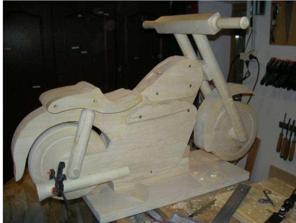
Il est important de veiller à ce que les roues touchent le plateau de la bascule. Procéder à l'équilibrage de l'ensemble en bougeant la moto sur le plateau de telle façon que celui-ci soit horizontal au repos. Tracer l'emplacement. Le plateau ainsi que la calle seront percés afin de passer des tire fonds pour l'assemblage final.
