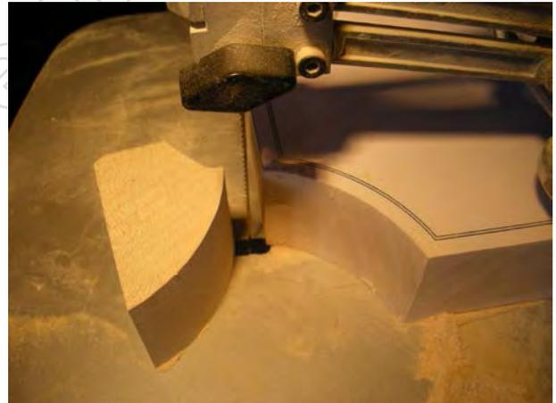
On perce un trou pour le passage de la lame et on découpe l'intérieur. J'ai utilisé une lame Pegas Skip N°7
