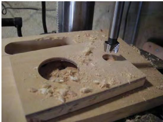
Une fois sec, sur l'envers du support et à 95 mm du bord, j'ai percé un trou de 15 mm de diamètre et de 8 mm de profondeur (mèche Forstner).
