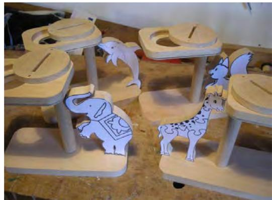
J'utilise la scie à chantourner pour réaliser les éléments décoratifs et le couvercle (66 mm de diamètre).
