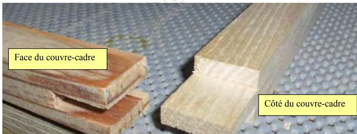
Sur la face interne réaliser une rainure de 5 mm de large et 5 mm de profondeur et située à 10 mm du bord inférieur. Cette rainure servira à loger le contreplaqué du couvre cadre.
