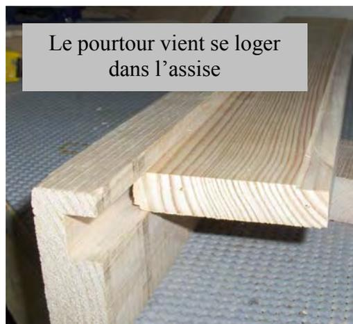
Assembler le fond : la rainure des assises est encollée, on y introduit la planche d'envol et les trois morceaux du pourtour. Equarrer et serrer avec des serre-joints. Ne pas oublier de fixer la baguette d'assise arrière (colle et/ou clous).
