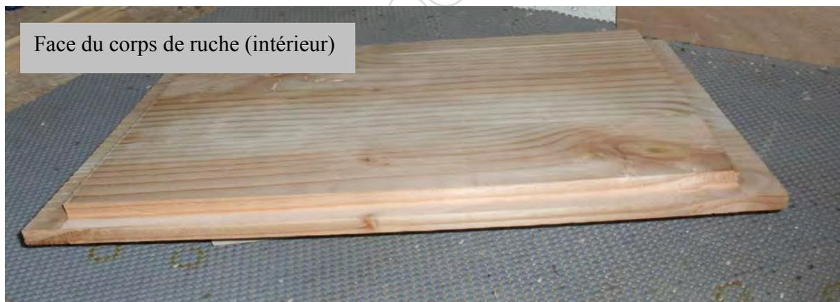
Ensuite tracer un trait sur l'extérieur des faces avant et arrière à 12 mm du bord de la hauteur (310 mm) puis pré-percer et fraiser les trous qui recevront les vis. Compter 5 vis par arêtes.
