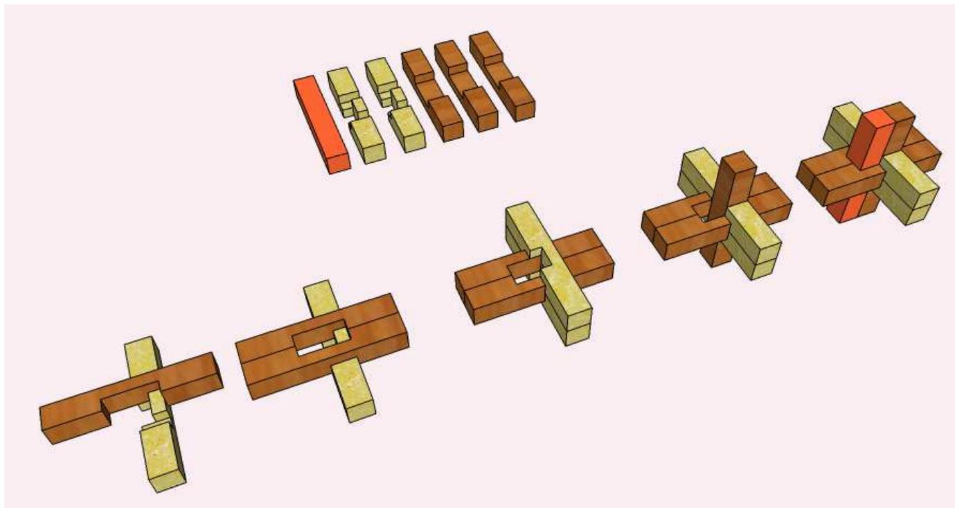
Les pièces doivent être de section parfaitement carrée et les découpes doivent être réalisées avec la plus grande précision.
