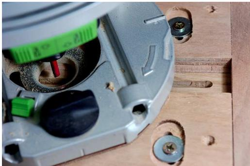
Il suffit s'insérer le morceau dans le gabarit, le bloquer et de passer la défonceuse en deux passes. (j'ai cassé une fraise en voulant faire ma rainure d'un seul coup...).
