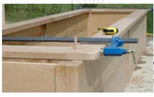
Même l'angle du pourtour est réalisé en tenon/mortaise
