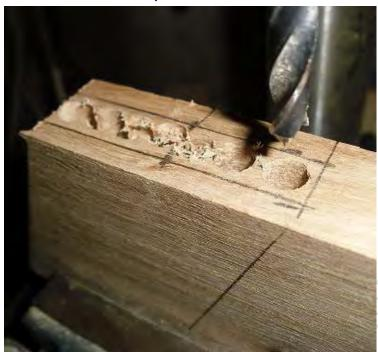
Réalisation d'une mortaise en bout, selon un angle de 65°. Pour cela on perce à des profondeurs croissantes (mèche de 8), maximum de profondeur à 70mm
