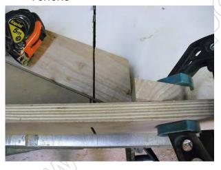
Selon le même principe que les encoches, on coupe l'épaulement du tenon à la scie circulaire en s'aidant des guides.
