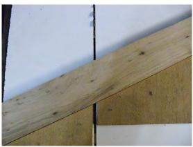
On réalise les encoches, largeur 20 profondeur 10. Pour cela on a découpé une planche à 25°, les 2 morceaux serviront de guide. Il suffit de les fixer au plateau de sciage (photo), et faire plusieurs passages sur la scie circulaire avec la lame sortie de 10mm au dessus du plan du gabarit. On retournera les guides pour l'autre montant, une cale préréglée permet de conserver une largeur constante sur toutes les encoches.
