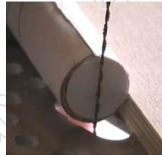
Un guide est bridé sur la table de la scie à chantourner. Il est placé de telle manière que la découpe commence sur le trait du diamètre.
