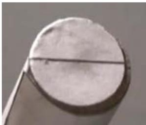
En bout, on place ce morceau de papier permettant d'avoir le tracé du diamètre.
