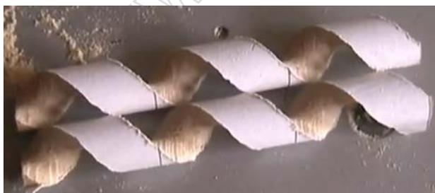
Lors de la découpe, le morceau de bois reste plaqué sur le guide. On se contente donc de le tourner en suivant le trait de coupe. Voici ce que l'on obtient.
