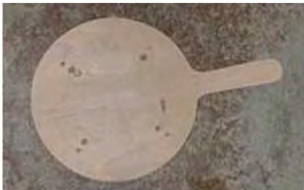
Découper un cercle de 200 mm de diamètre en laissant un manche de 30 à 40 mm de largeur. Sur un diamètre. de 150 percer des trous de 6 mm de diamètre de 6 mm de profondeur. La fixation des poules se fait à l'aide de tourillons 6\*20. Sur un diamètre. de 120 mm, on perce des trous de 4 mm de diamètre. Un petit chanfrein des 2 côtes est réalisé pour passer les ficelles.
