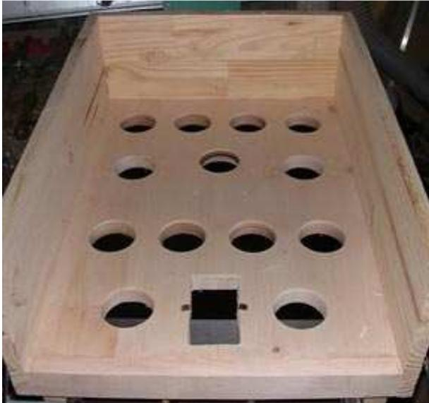
Le plateau terminé, les côtés sont montés à blanc. Deux petites rainures sont usinées sur les côtés du moulin afin d'y loger les axes du moulin.
