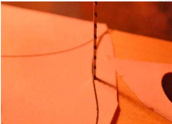
Effectuer le découpage des pièces à la scie à chantourner en restant bien tangent à l'extérieur du traçage.
