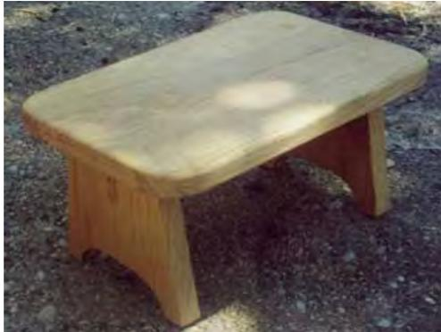
Il a été réalisé en frêne (plateau de 27 mm d'épaisseur raboté pour obtenir du 20 mm fini).
