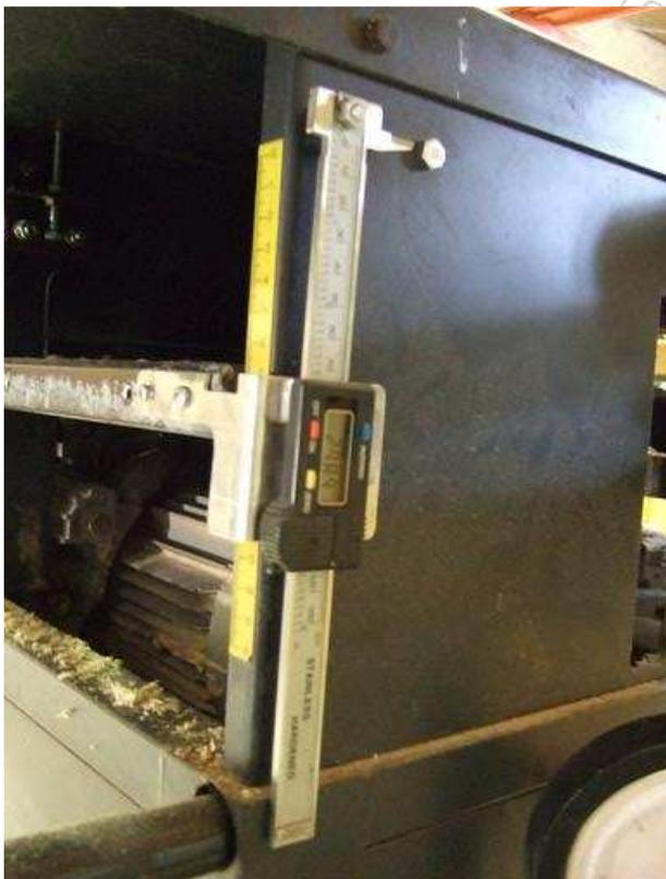
D'où la nécessité d'un vernier numérique sur la table de mortaiseuse
