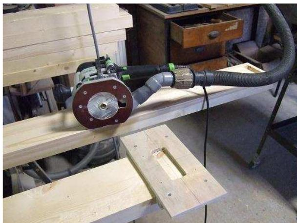
Réalisation des tenons et des mortaises du châssis porteur.
