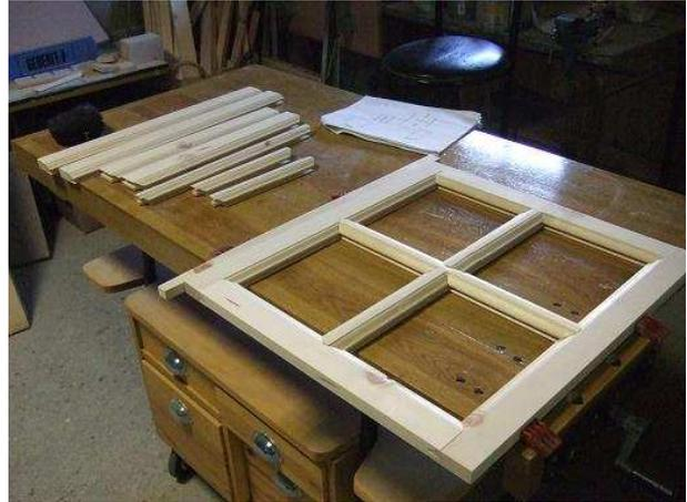
Les fenêtres et la porte sont de réalisation classique par assemblage profil-contre profil
