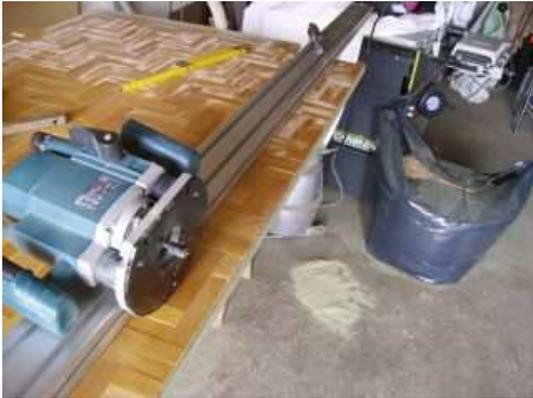
Les 5 derniers millimètres seront arasés sur une demi épaisseur du plateau à la défonceuse guidée le long d'une règle avec une fraise droite ce qui permettra d'avoir une coupe nette surtout côté parement.
