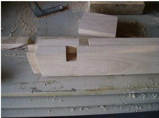
Deux encoches dans les petites traverses de la ceinture, permettront le passage des glissières.
