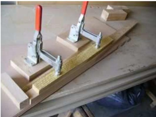
La réalisation des quatre glissières (deux par allonge) ne pose pas de problème : traçage, pré découpe à la scie sauteuse où a ruban.
