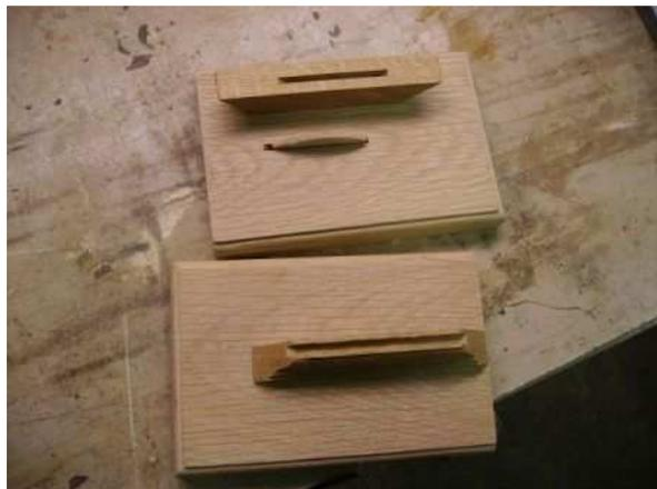
Réalisation des deux supports : Le cadre sera assemblé sur ces supports avec deux lamelles.
