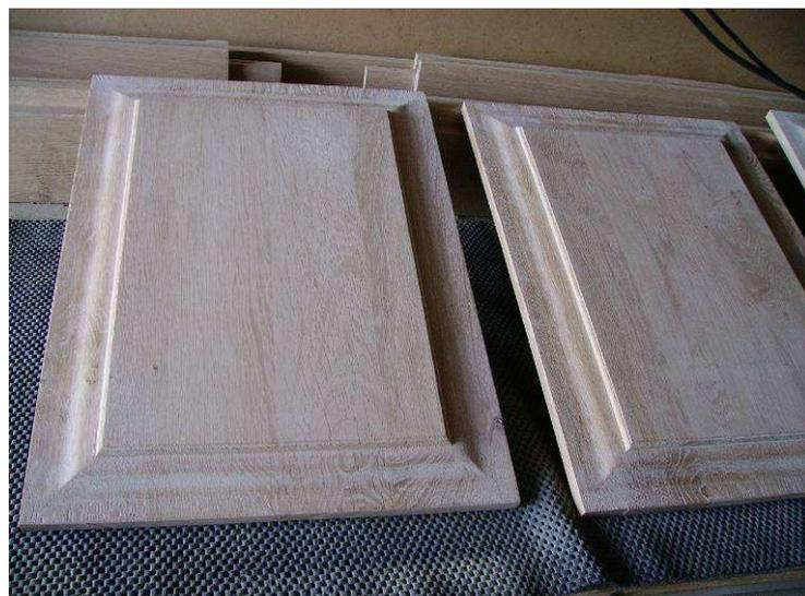
Les panneaux à plates bandes, simple parement ont une épaisseur de 24 mm. Après ponçage, il vaut mieux teinter les panneaux avant assemblage.
