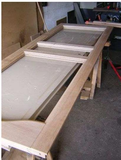
Si vous avez choisi des assemblages chevillés avec ou sans collage, c'est le moment de percer les montants de part en part au niveau des mortaises. Procédez maintenant à un premier assemblage qui permettra de vérifier les arasements des différents éléments. Les tenons devront entrer dans les mortaises sans forcer (surtout s'ils doivent être collés)
