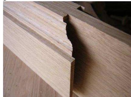
Tracez les chapeaux de gendarme des traverses hautes, faites une prédécoupe puis calibrez à la toupie en ayant préalablement fixé le gabarit au niveau des tenons. L'usinage final pourra se faire au calibre et lunette. Cette dernière venant en appui sur un gabarit
