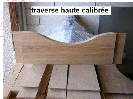
De la même façon, procédez au moulurage et au rainurage. Tous les autres éléments seront moulurés et rainurés au guide droit
