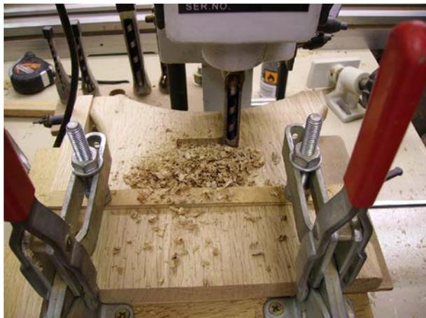
A l'aide d'un gabarit de positionnement fixé sur la mortaiseuse à B<sup>2</sup>, j'ai réalisé les mortaises non traversantes.
