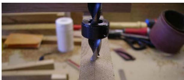
La pose des barreaux ne présente pas de difficultés particulières. Il faut tout de même faire attention à ne pas percer trop profondément aux quatre angles, pour cela j'ai utilisé des butées de perçage. En s'alignant sur un trait d'axe, percez à un diamètre de 6 mm pour des tourillons de 6.
