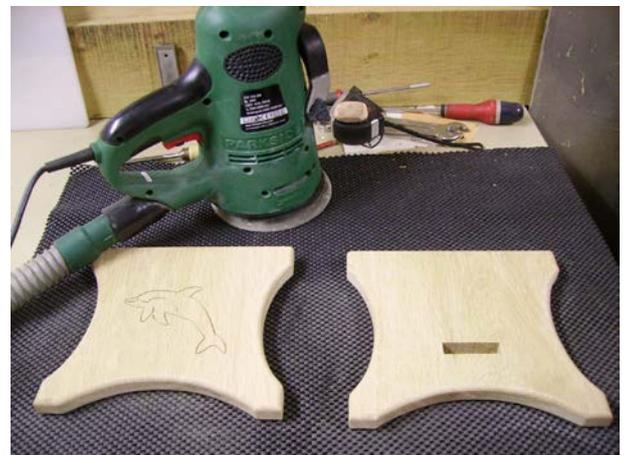
Les tenons de la traverse (longueur des tenons à adapter à la profondeur des mortaises réalisées précédemment) sont réalisés à la toupie. Avec la défonceuse équipée d'une fraise quart de rond les angles ont été arrondis.
