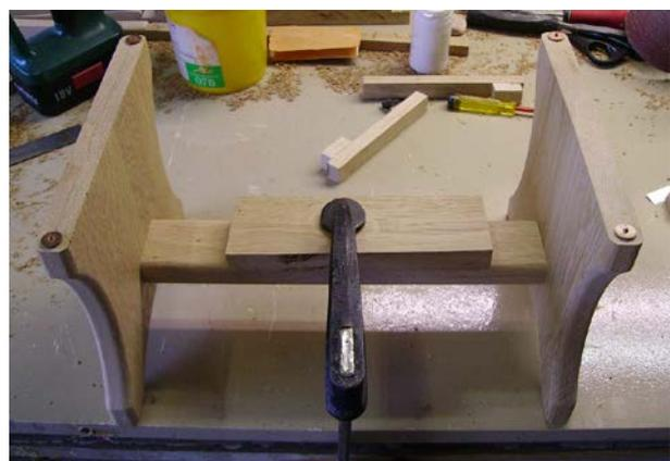
Placez des centreurs dans les trous et avec un débord de 5 cm à chaque extrémité des barreaux, marquer l'emplacement du perçage des deux premiers barreaux.
