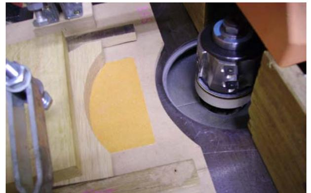
Avec une défonceuse et une fraise quart de rond, adoucir les angles des trois côtés sur les deux faces au niveau des échancrures uniquement ainsi que sur les deux angles du bas qui seront en contact avec le sol pour éviter des éventuels éclats
