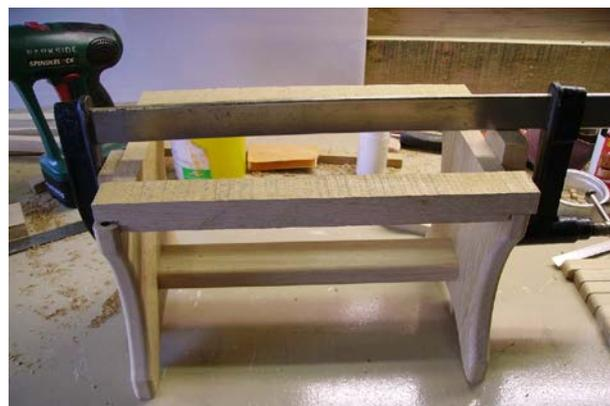
L'assise du banc sera réalisé avec 9 barreaux de 15x20x400 mm, c'est aussi une façon d'utiliser les chutes. Les 9 barreaux mis côte à côte sont maintenus avec un serre-joint afin de réaliser sur le pourtour un petit arrondi à la défonceuse. Puis ponçage, grain 120, 220 et 400.
