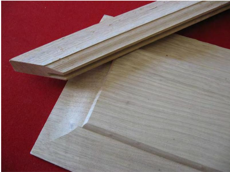
Réaliser une plate bande, c'est amincir à une cote donnée les quatre côtés d'un panneau préalablement assemblé à partir de planches usinées de façon à ce que ce dernier s'intègre dans les rainures d'un cadre.
