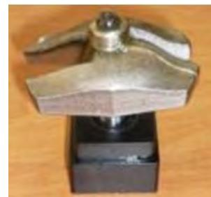
Fraises de défonceuse queue de 8mm avec roulement de guidage. Avec de tels outils, les capacités en largeur de plate-bande sont réduites
