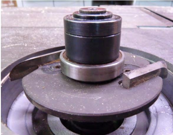
Voilà ce que l'on doit avoir. On remarque que le roulement à billes est au dessus des couteaux et que les bagues libèrent l'extérieur du roulement.
