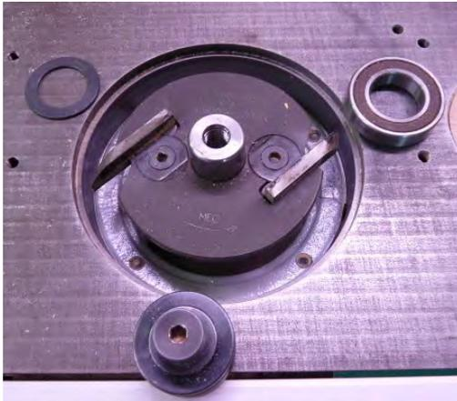
Le diamètre du plateau à utiliser est limité par celui du puits de toupie.
