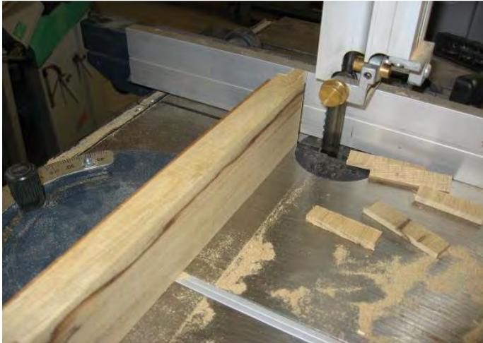
Après avoir effectué cette opération sur TOUTES les pièces présentant un tenon identique, régler le guide parallèle à la profondeur de tenon désirée, puis à l'aide du guide d'angle réglé à 90°, séparer les joues.
