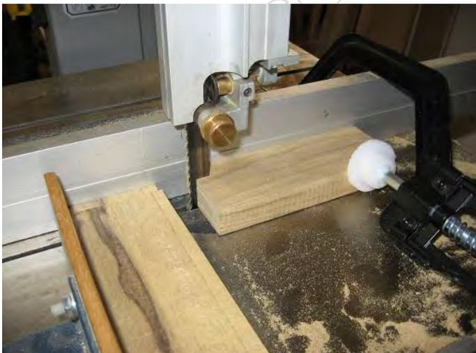
Pour éliminer les chutes et afin que la profondeur soit précise, je fais un trait de scie dans une cale afin de laisser dépasser les dents de la valeur souhaitée, je solidarise sur le guide parallèle, et après avoir régler la largeur, j'élimine mes chutes par retournement.
