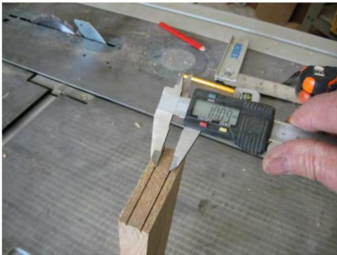
Prendre une chute de la largeur et de l'épaisseur des pièces à tenonner, s'en servir pour régler l'espacement entre le guide parallèle, et la denture côté guide (les dents d'une lame de scie à ruban sont avoyées, donc il y a des dents à droite et à gauche de l'axe théorique de la lame).
