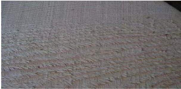
Pour ce qui est de l'usinage du chant, bien observer le sens des fibres. Les fibres parallèles à la table de dégauchisseuse ne généreront pas, en principe, d'arrachement de matière. Par contre, comme sur les photos, il faut dans la mesure du possible, que les fers couchent les fibres. A l'envers, on voit très bien l'arrachement de matière en sortie, l'usinage ayant été effectué en relevant les fibres.
