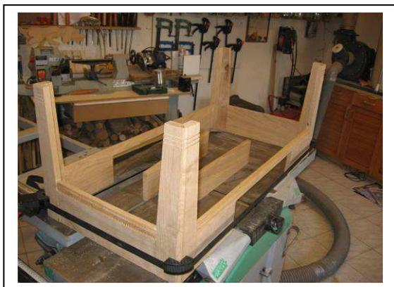
Cet ensemble ainsi assemblé, est positionné sur le plateau, et solidarisé par 4 vis.
