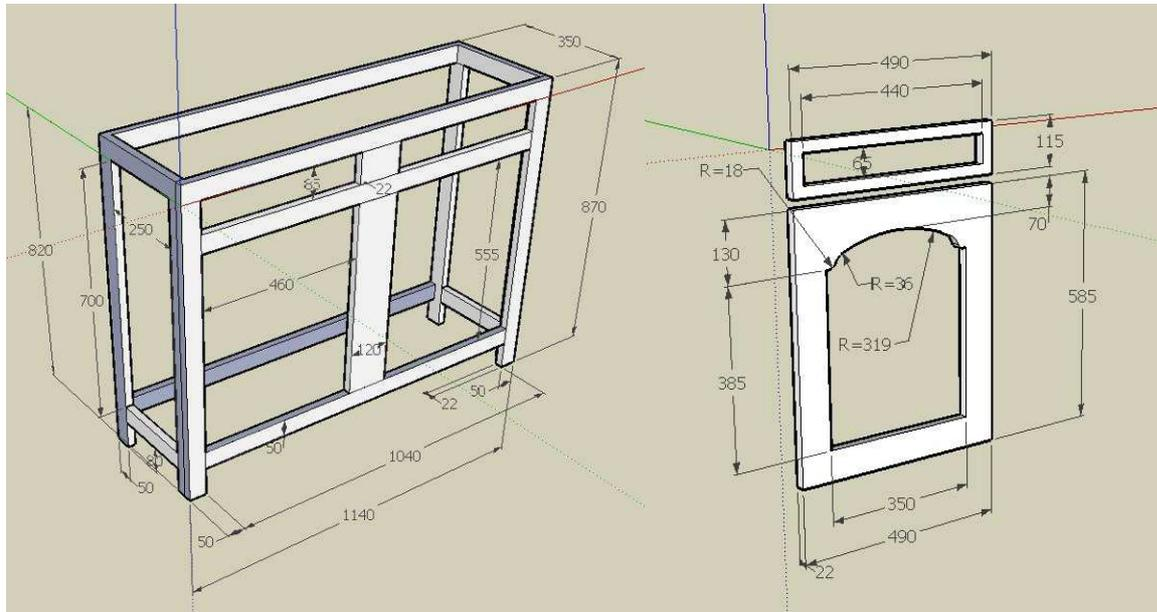
Ces ébauches de plans, sont suffisantes pour déterminer les enveloppes de réalisation des ensembles et la fiche de débit.
