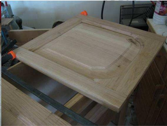
Tous les assemblages avec profil et contre profil. Les chapeaux des portes, ont été réalisés en copiant ceux de la cuisine existante. Ils peuvent être d'une toute autre forme. Fixation par fiches à lacet dégonnables.
