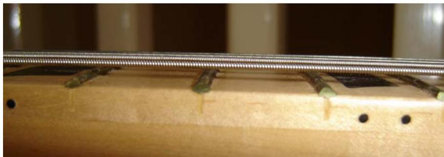
Pour pratiquer les rainures dans la touche, il faut être relativement précis, parce que leur positionnement détermine la 'justesse' de l'instrument. Il faut donc les scier au minimum à 0,5 mm près. Sinon, la guitare sonnera faux...
