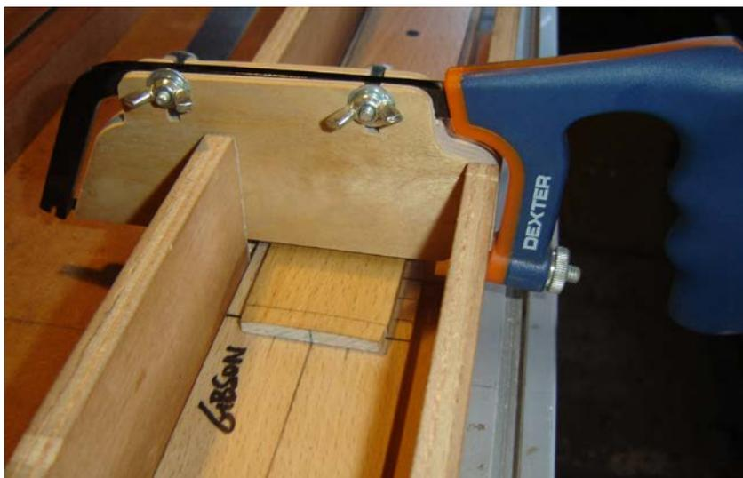
Ensuite, il suffit de coller (au double-face) la touche au bon endroit sur le gabarit. Puis, positionner ce gabarit dans la boîte dans le 'picot' prévu, scier la rainure, déplacer le gabarit d'un espace, scier la rainure, etc.
