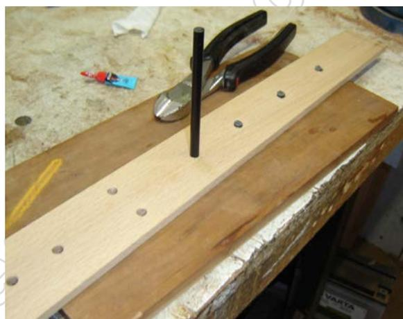
Après ça, il faut positionner les trous des 'inlays' (repères de touches) et y glisser un tronçon de cylindre en plastique (au autre), collé à la cyanolite.
