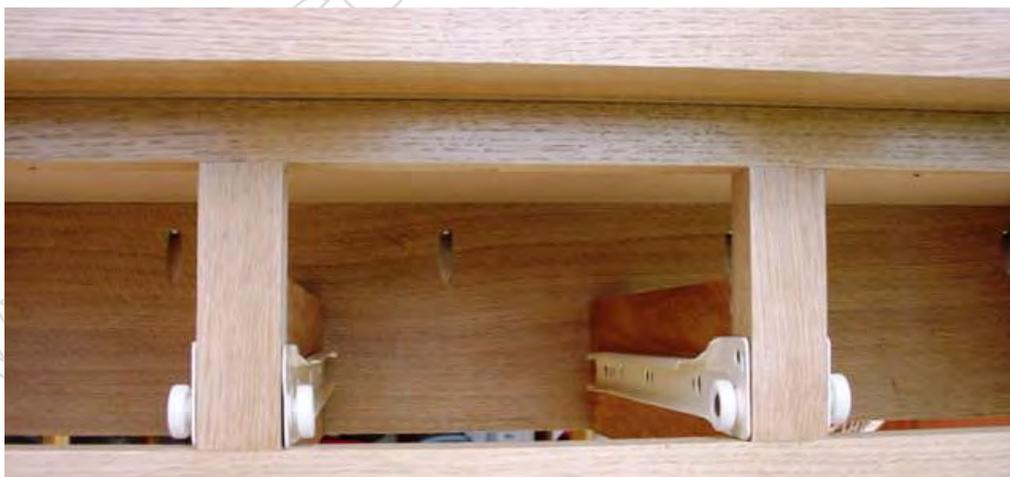
Il faut être soigneux lors du montage des coulisses (se faire un gabarit) d'autant plus qu'il faudra (à moins de posséder une visseuse avec renvoi d'angle) monter celles du petit tiroir avant d'assembler les traverses centrales.
