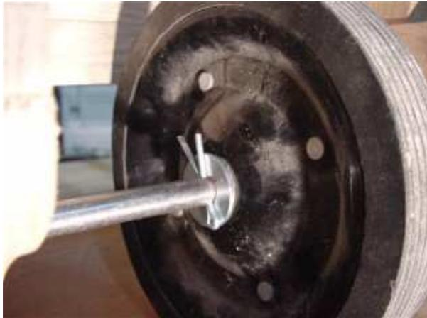
Le support de roue est percé aussi avec le même angle ( $5^\circ$  ici). Attention, il faut avoir  $+5^\circ$  et  $-5^\circ$  !
