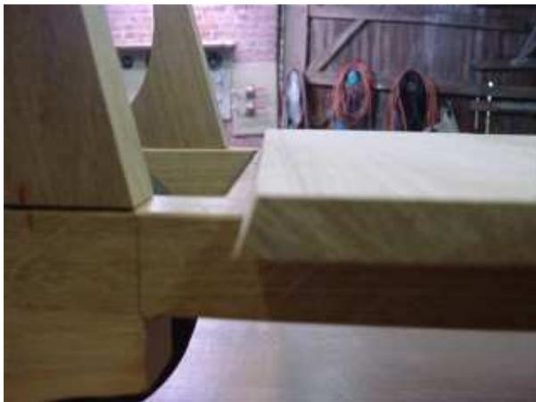
L'avant de ce qui va servir de plateau est découpé avec un angle de  $15^\circ$  (angle du support). On fait de même pour ce qui va servir de devant.
