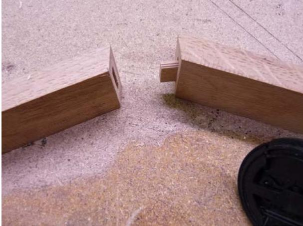
Après avoir débité (angle  $67,5^\circ$ ) les morceaux avec une scie radiale, il faut les assembler. J'ai opté pour une solution utilisant des dominos (fausses languettes). On doit aussi pouvoir utiliser des tourillons, mais le perçage risque d'être délicat. Le nez de marche n'est pas assez haut pour utiliser des lamelles.
