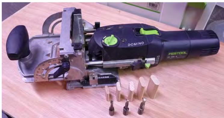
Ce modèle permet, en changeant de fraise, de réaliser des mortaises de 5, 6, 8 et 10 mm d'épaisseur. Depuis, Festool a sorti un autre modèle permettant d'utiliser des dominos plus épais et plus longs.
