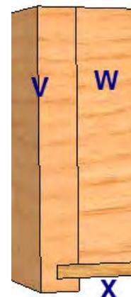
Le fond X est glissé dans les rainures. L'arrière (W) est vissé sur les côtés et est cloué sur le fond.
