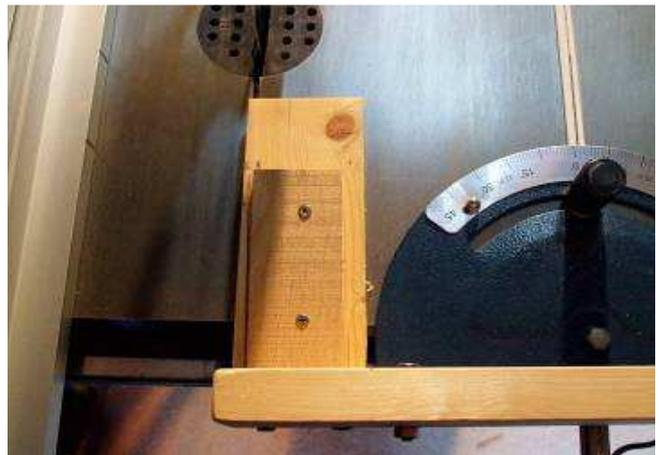
Réglage à environ  $1,9^\circ$  du guide d'angle
