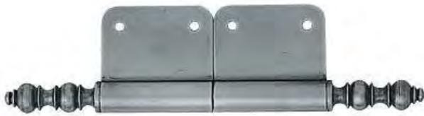
Les fiches à larder. Pour les poser, il est nécessaire de faire une entaille dans le chant de la porte et dans le bâti. Cette entaille peut être réalisée avec un bédane à larder.
