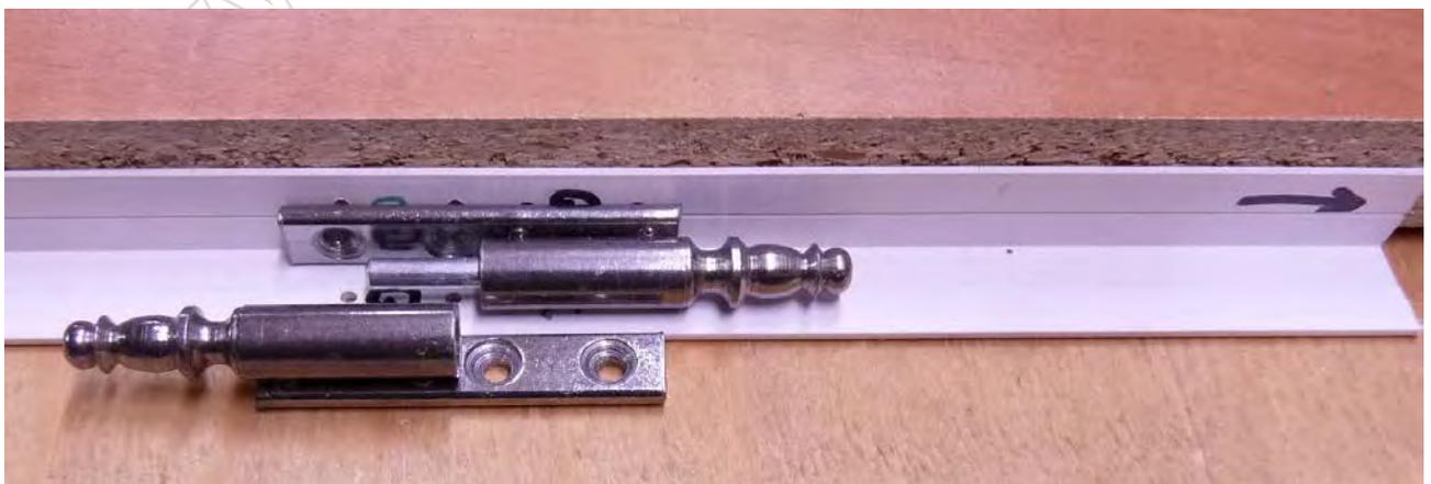
Vérification du bon positionnement des paumelles avant perçage.
