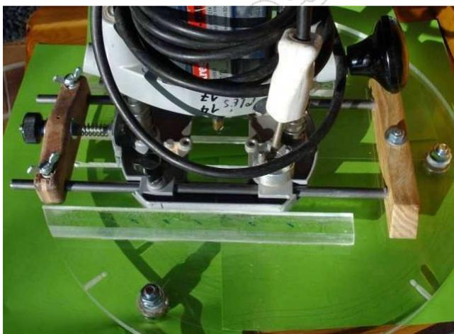
Vous pouvez aussi remarquer sur la photo de droite une vis M4 insérée dans le chant du disque plexi. J'ai percé 4 trous taraudés dans le chant du disque afin d'y placer des vis pouvant servir de butées en cas de fraisage d'arcs de cercle.
