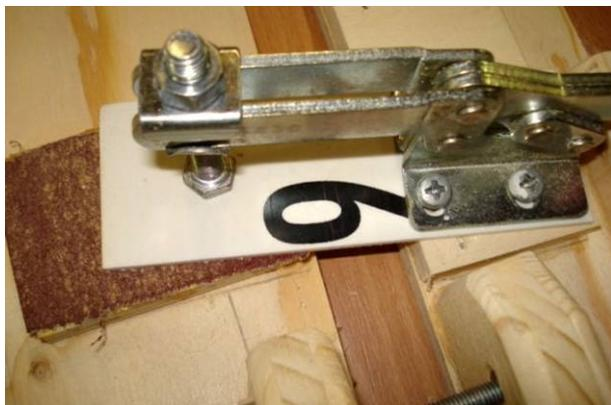
Le blocage de la partie mobile est assuré par une seconde sauterelle. Ce blocage m'a posé quelques problèmes. En effet, le déplacement de la partie caoutchoutée de la sauterelle se faisant en arc de cercle, avait tendance à tirer vers l'arrière la partie mobile de quelques 1/10 de mm, c'est peu, mais quand même !
