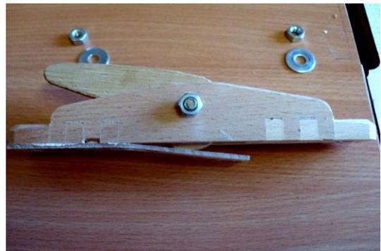
Le même en position fermée. On remarque la languette qui appuiera sur le guide
