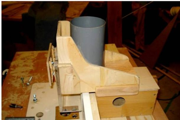
Vous pouvez voir sur cette photo le départ de l'aspiration latérale qui sera raccordée au capteur sous table placé à la gauche de la fraise. Ce flexible peut aussi servir à l'aspiration des poussières qui auraient pu échapper au système d'aspiration installé.
