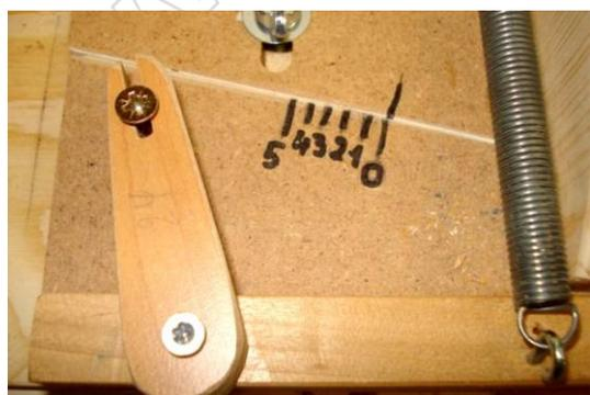
Autre amélioration, le réglage de l'avancement de la joue gauche. Sur le précédent guide, l'avancement du « coin » mobile était aussi assuré par une molette, mais il fallait de nombreux tours pour faire avancer d'1mm la joue. Sur ce nouveau guide, j'ai monté un système de fourchette qui permet un réglage beaucoup plus rapide.
