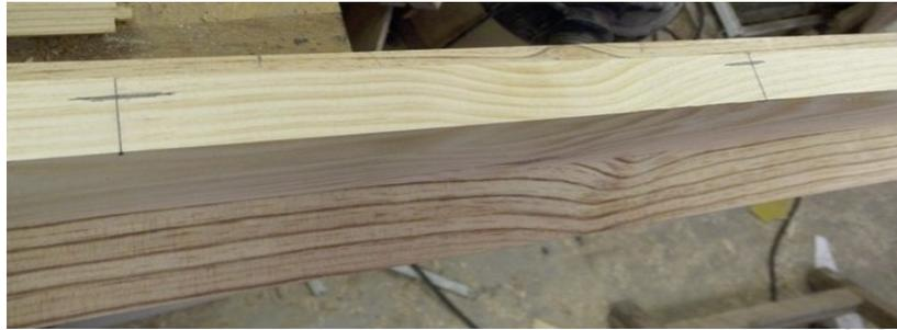
Vous voyez ci-dessus le traçage de 2 ensembles de mortaises, le trait longitudinal ne sert qu'à indiquer la face à poser contre la mortaiseuse (parement).
