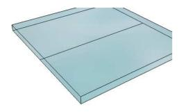
Pour chaque dimension de tenon, il vous faudra préparer une plaque de plexiglas qui aura la largeur de la semelle de la défonceuse employée, plus la largeur du tenon, moins le diamètre de la fraise.
