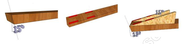
Il faut couper dans une chute deux triangles dont un des angles est à 15°. Ces triangles seront collés au double-face (en rouge sur le dessin) sur le bout du bois à mortaiser. Sur ces triangles, de nouveau à l'aide de double-face, on viendra coller la mortaiseuse afin qu'elle ne se déplace pas lorsque l 'on bridera la mortaiseuse sur le bois.
