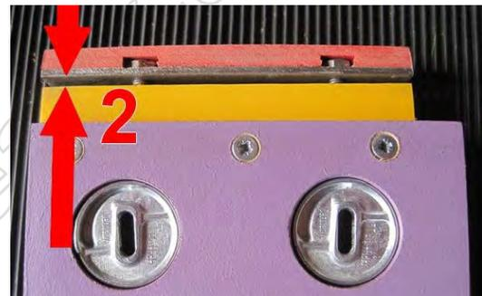
En position fermée, après rotation d'un quart de tour dans le sens horaire, le blocage doit être ferme.
