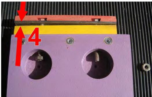
Mettre en place le chariot et visser les écrous dans les trous Ø25. Dans un premier temps, régler les écrous de telle sorte que le jeu du chariot soit d'environ 4 mm sans les excentriques.
