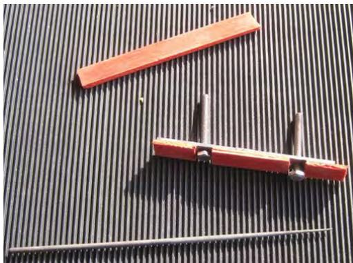
Mettre en place les deux vis filetées de 4x35 tête hexagonale. Découper un des morceaux de PVC 90 x 10 en trois parties et les coller (époxy) sur le fer entre les têtes.
