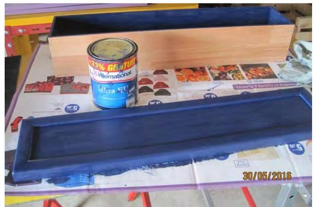
Après séchage, poncer et peindre l'intégralité du couvercle, de même que l'intérieur et le dessous de la boîte (peinture utilisée : reste d'antifouling pour bateau en 2 couches. La pénétration est excellente ; utiliser des gants !)
