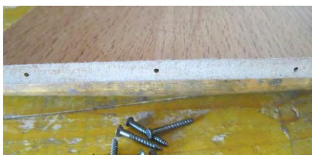
Visser une longueur et une largeur ensemble en plaçant une équerre à l'intérieur maintenue par deux pinces. Assembler ensuite les deux parties obtenues, puis, fixer le fond en dernier.
