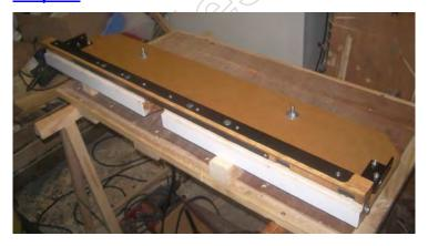
Fabrication du règle sur lequel glisseront les pièces à usiner. Le règle se déplace le long de la table électriquement au 10 ème de millimètre.
