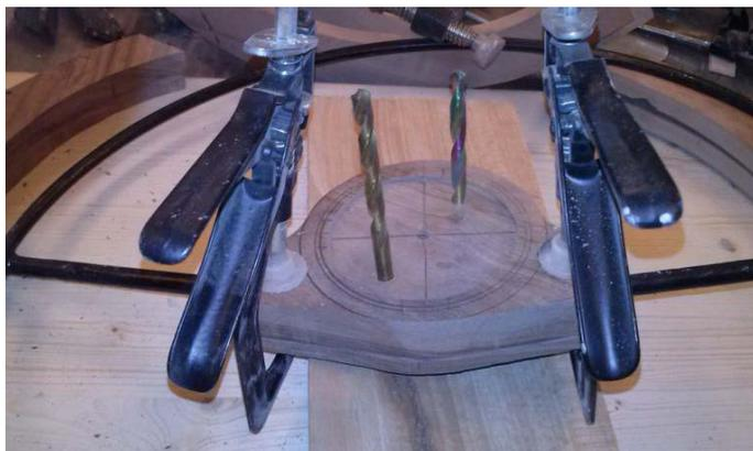
Pour la partie centrale, réalisée en partie au tour à bois, j'ai laissé presque jusqu'au moment du collage une zone technique me permettant un centrage sur l'armature à l'aide de deux forets de 7 mm.
