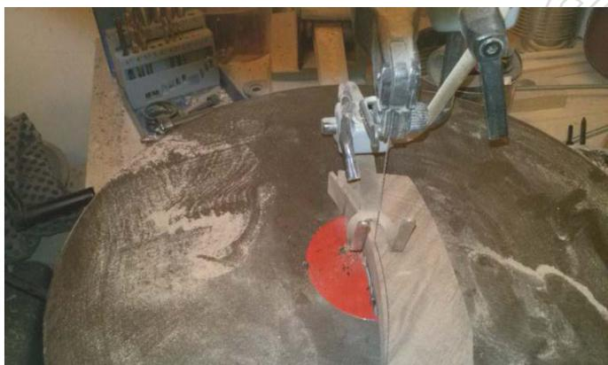
Découpage au tracé des intérieurs de la partie périphérique du volant à l'aide de la scie à chantourner. En effet, ceux-ci présentent des rayons de raccordement avec la partie centrale, et je n'ai trouvé que cette méthode pour être assez précis. Il va sans dire, que partout, il y a finition au cylindre ponceur ou au touret. Des cotes précises ne sont nécessaires que pour le moyeu, et la concentricité.
