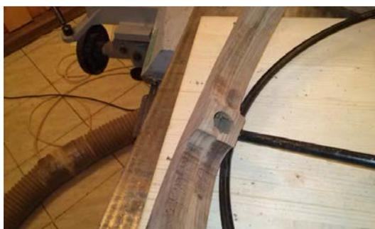
La partie qui m'a posé le plus de problèmes, a été le creusage. J'ai opté pour un usinage à la perceuse à colonne à l'aide d'une fraise arrondie de défonceuse, avance manuelle, en plusieurs passes de profondeur réduite.
