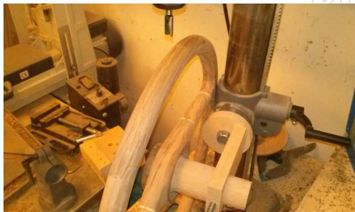
Après un essai peu concluant de réalisation des empreintes avec un montage « maison » pas assez rigide, j'ai dû me résoudre à les réaliser à la lime à bois pour dégrossir, et à la lime métal pour la finition. Seul le moyeu en bois du montage a été conservé afin de faciliter la prise à l'étau.
