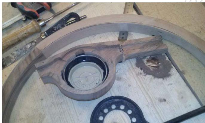
La périphérie de l'armature est prise en sandwich, le logement du cabochon central est terminé, les ajustements entre les 7 demi parties ainsi que les creusages sont également terminés. La phase délicate du collage va suivre.
