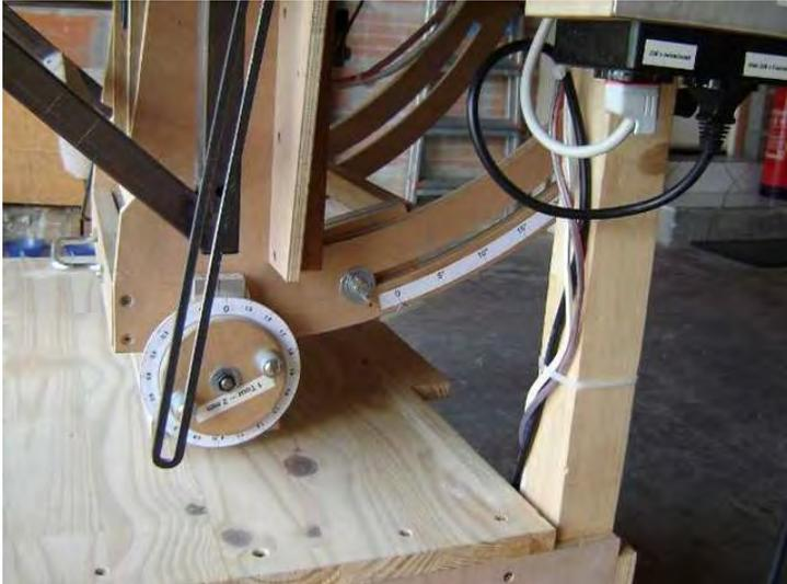
Le réglage fin de la hauteur de fraise s'effectue manuellement avec la manivelle. La position du zéro peut être modifiée à souhait. Elle est conservée lorsque l'axe tourne.
