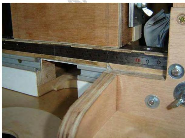
Les butées se déplacent manuellement le long de règles millimétriques. Elles se verrouillent avec des vis à oreilles
