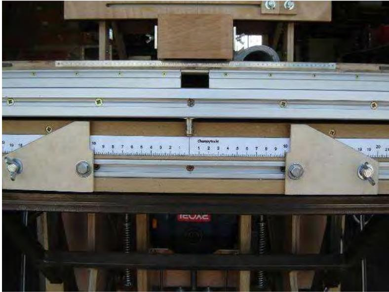
Les butées de déplacement en Y de la table croisée se règlent le long d'une bande millimétrique fixe (perso...).
