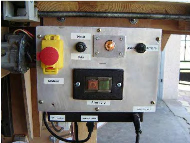
L'inverseur marqué 'Avant/Arrière' permet de régler le guide parallèle avec le moteur dédié. Ce mouvement se transforme en une montée ou descente du guide et de la table croisée annexe en configuration verticale.
