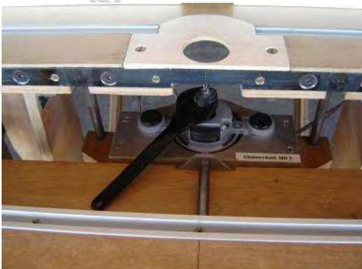
La fraise se monte et se démonte par le bas. Il suffit d'ouvrir la table croisée vers soi pour accéder avec aisance au mandrin.
