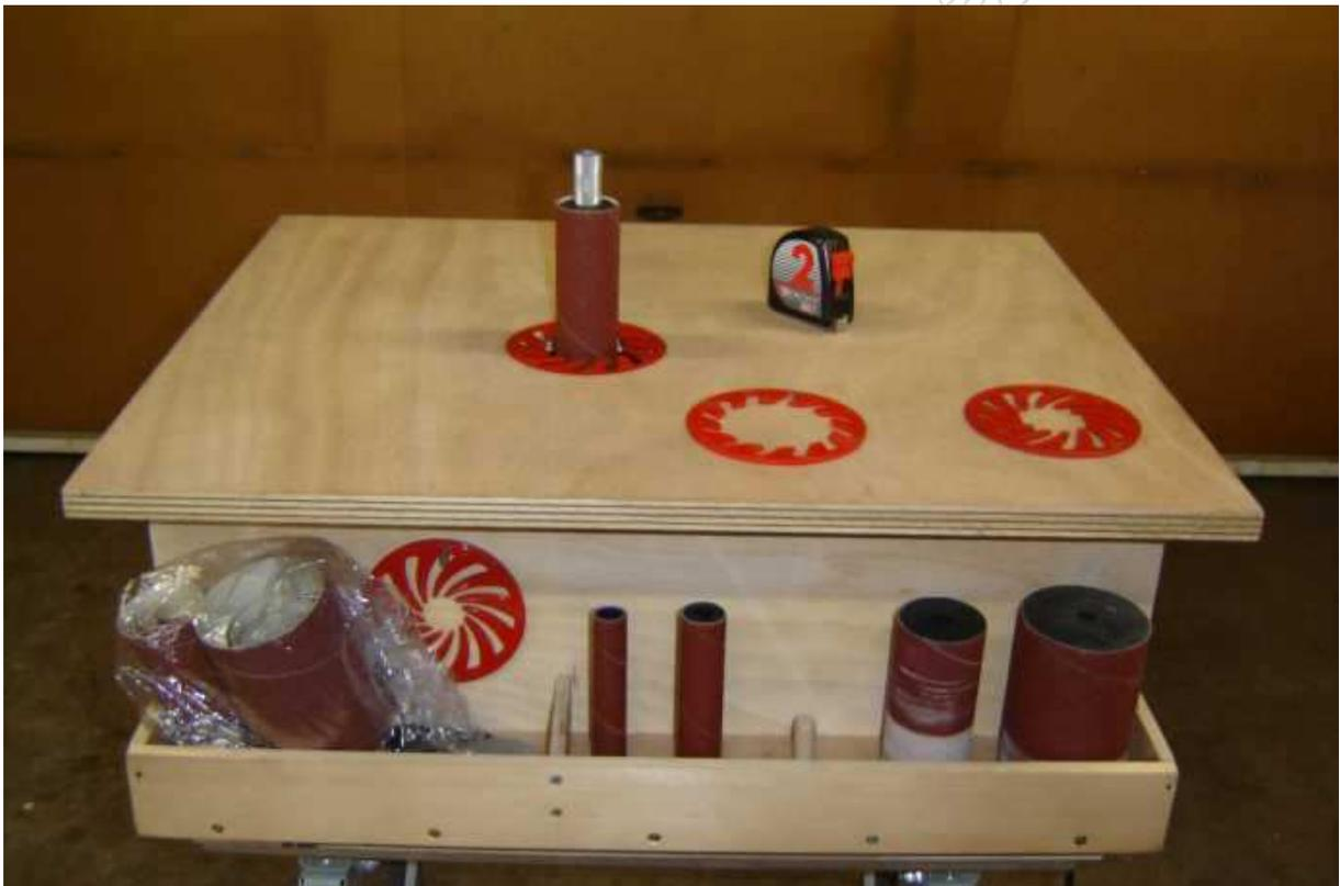
J'ai acheté un set de rouleaux ponceurs chez 'Delta' comprenant 5 rouleaux en caoutchouc, 5 cylindres abrasifs (120) et 5 bagues adaptées aux divers diamètres (en côtes impériales...).
