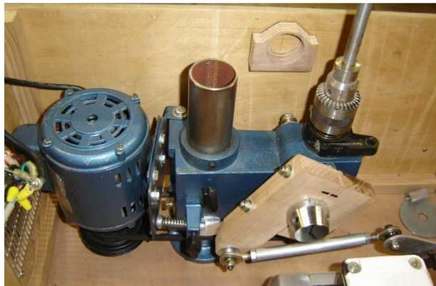
La perceuse montée avec la tête en bas, la colonne raccourcie et la came montée sur l'axe de manœuvre du mandrin.
