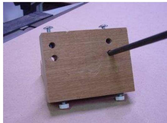
J'ai percé deux trous afin de permettre le passage des tiges : en réalité, j'en ai percé quatre pour pouvoir disposer de deux hauteurs différentes.
