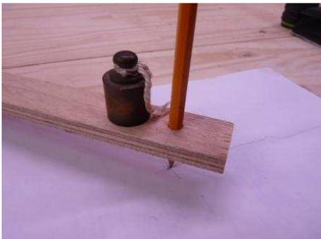
Le crayon (hexagonal) est inséré « en force ». L'ensemble peut être lesté pour que la pointe du crayon soit bien en appui sur la feuille.
