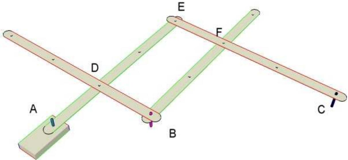
Inventé vers 1630 par l'astronome allemand Christoph Scheiner, le pantographe est un instrument de dessin qui permet de faire des agrandissements ou des réductions d'une figure en utilisant l'homothétie.
