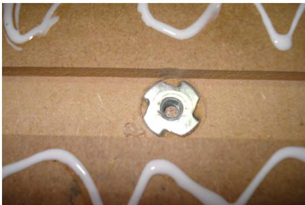
Vous voyez ici cet écrou placé dans la rainure. Il ne doit pas dépasser sous peine d'empêcher le passage de la barre de l'allonge de butée.
