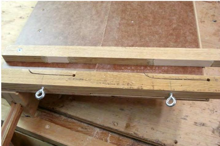
hygrométrique, j'ai collé sur la barre de droite du traîneau une bande de couvre-chant stratifié. Sur la barre de gauche j'ai pratiqué des découpes où j'ai aussi collé des bandes de stratifié ; en face de ces découpes, j'ai fait des trous taraudés M5 dans lesquels des vis permettent de régler la pression sur la barre guide.
