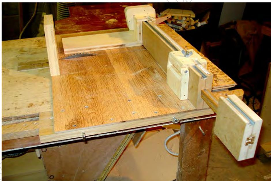
Ce petit traîneau a quelques avantages, tout d'abord un encombrement moindre, ensuite le guide est continu ce qui permet de passer la butée de gauche à droite ou de droite à gauche sans être gêné par la protubérance centrale, cette caractéristique permet aussi l'emploi d'autres accessoires facilitant le travail, enfin par le profil bas du guide on a une meilleure vue sur le travail à effectuer.
