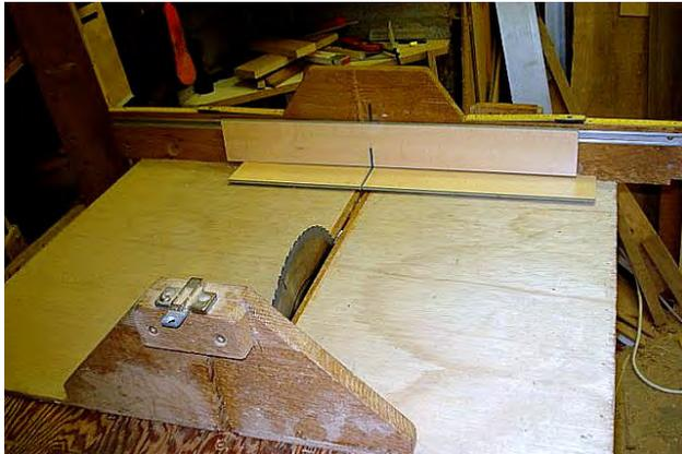
Ce traîneau permet de faire des coupes transversales sans aucun danger. Je n'ai jamais eu le moindre rejet lors de l'utilisation de ce traîneau, **C'EST MÉCANIQUEMENT ABSOLUMENT IMPOSSIBLE.**
