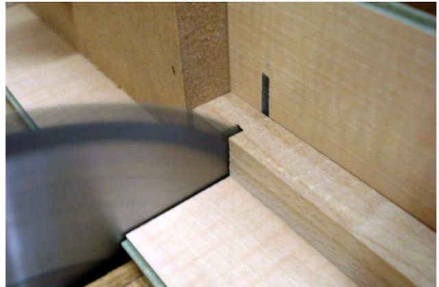
Afin d'avoir une coupe très propre, j'ai utilisé une lame 250 mm 60 dents à denture alternée droite / trapézoïdale qui fait des coupes extrêmement propres, presque polies (surtout sur du hêtre !). En plus, sur le traîneau j'ai collé au ruban double face 2 chutes de lame de parquet afin d'avoir le trait de scie exactement de la largeur de la lame, ce qui fait un pare-éclats efficace.
