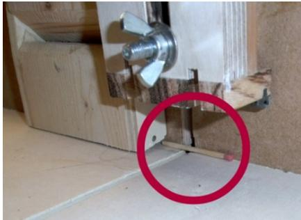
L'allumette est posée en appui contre une butée et contre la barre du traîneau, le presseur est remonté.
