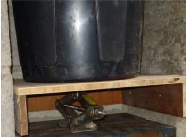
Au lieu de suspendre la poubelle au couvercle comme c'est le cas sur le cyclone N°2, ce qui nécessite en cas de changement de poubelle, le dévissage et le revissage des 4 points de suspension, j'ai décidé d'appliquer la poubelle au couvercle en la poussant par en-dessous à l'aide d'un cric. Bien sûr il m'a fallu intercaler un panneau entre le cric et le fond de la poubelle
