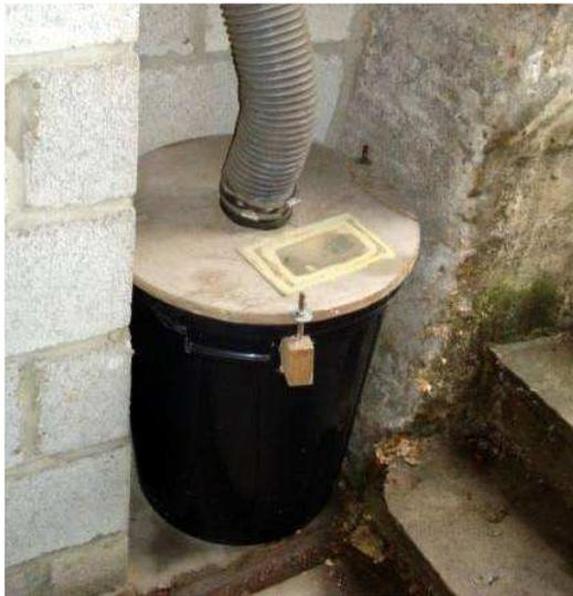
Le tuyau souple de +/- 50cm placé entre le cyclone et la poubelle freine fortement le mouvement giratoire des copeaux qui tombent alors verticalement. De ce fait, ces copeaux se déposent au centre de la poubelle formant un cône très aigu qui vient rapidement boucher l'orifice.
