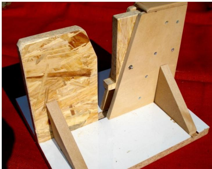
Cet accessoire d'atelier, très simple à réaliser, sert à maintenir debout un panneau afin de traiter un chant, par exemple pour y coller un couvre-chant.
