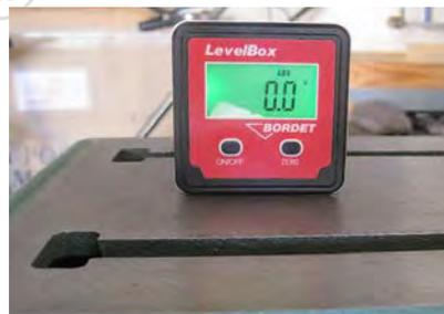
Tout d'abord, la machine elle-même. Son socle doit être horizontal (gauche/droite et aussi avant/arrière). Le réglage s'effectue grâce aux pieds du meuble support.
