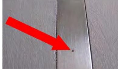
La règle de positionnement se place à l'arrière, contre la cale PVC, sa rainure sur la ligne, et à l'avant, sa rainure sur le point rouge.
