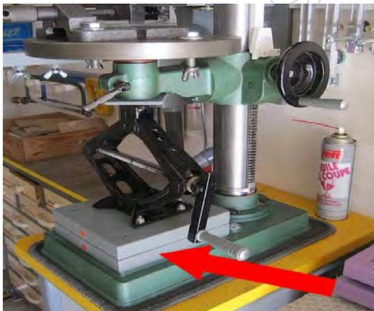
Le socle du cric est réalisé en deux parties simplement emboîtées l'une sur l'autre. Ce système permet d'ajouter une cale d'épaisseur (en violet sur la photo de droite) si nécessaire.
