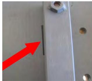
Enfin, la table doit être horizontale. Dans le sens gauche/droite un très léger défaut a été supprimé. Une fine feuille de PVC a été glissée sous le tube arrière, à gauche.
