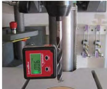
La colonne de la perceuse doit être verticale. On peut agir sur la fixation murale ajoutée. Il faut de même vérifier le foret placé dans le mandrin, vertical lui aussi.
