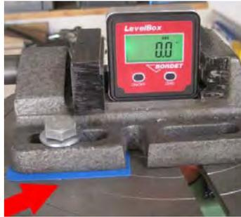
La table d'origine doit être horizontale. Pour le réglage gauche/droit, on agit sur le boulon situé sous la table. Pour celui avant/arrière, on utilise une cale pour compenser le défaut original de la machine vu précédemment. Donc, sans le cric, on glissera sous l'étau une cale en plastique (bleue sur la photo).
