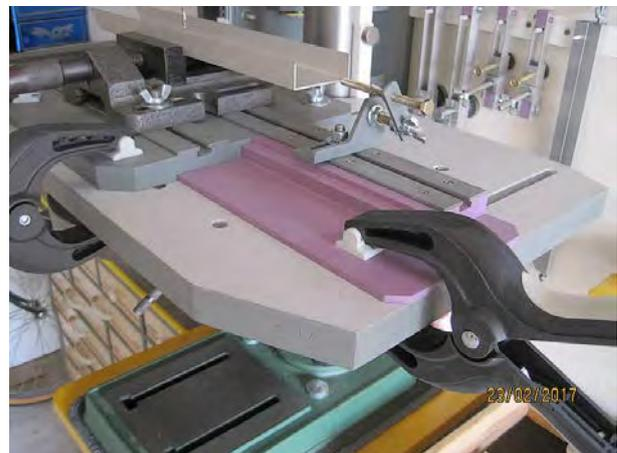
Enfin, l'étau peut aussi être utilisé sans fixation, pour le perçage des petites pièces à un faible diamètre, par exemple. C'est alors simplement son poids qui le maintient en place sur un autre plateau recouvert de papier de verre qui vient s'emboîter dans les deux rainures centrales, en haut de la table.
