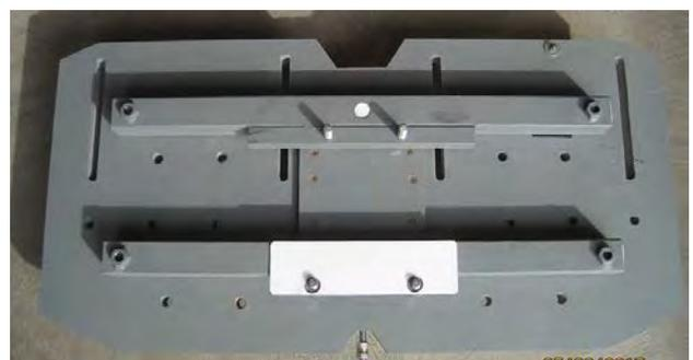
Le fait de placer la table sur des tubes permet d'utiliser aisément des pinces de serrage ou des serre-joints pour le bridage des pièces. Mais on perdra en capacité de perçage la hauteur de ces tubes.
