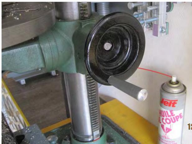
D'autre part, j'ai dû remplacer la manivelle qui était cassée lorsque j'ai acheté la machine. J'ai monté à sa place un volant à manivelle que je trouve plus pratique, surtout en fin de parcours pour régler finement la hauteur de la table. Ne possédant pas de tour à métaux, je l'ai réalisé en bois, puis peint en noir.
