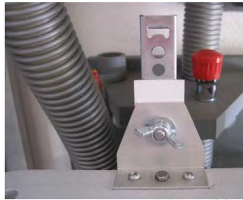
En outre, un boulon (Ø6), lui aussi équipé d'un écrou papillon, se trouve sur la glissière verticale du côté gauche.
