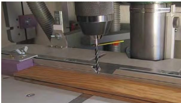
Il s'agit d'un morceau de règle en aluminium de 700 de longueur qui peut coulisser perpendiculairement à la table. Selon le besoin, elle est maintenue par 2 ou 4 boulons munis d'écrous papillon. Elle comporte une butée mobile qui coulisse sur un rail et qui se bloque à l'aide d'un écrou papillon. Celle-ci peut être mise en place, au choix, du côté gauche ou droit.
