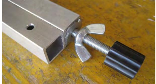
Le réglage fin s'effectue en tournant le bouton noir de l'extrémité et le blocage avec l'écrou papillon. Le trou visible sur la photo permet de ranger la butée en la suspendant.
