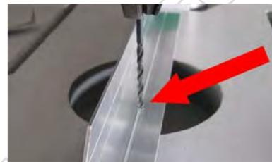
Dans cette position, la pointe d'un petit foret Ø3 monté dans le mandrin, vient se loger également dans sa rainure. Ceci permet de vérifier que le milieu de la table est bien aligné avec la tête de la perceuse.
