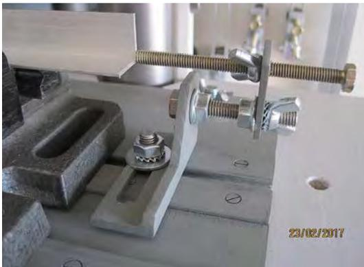
L'étau est fixé sur le rail métallique par deux boulons coulissants dans des rails en T et munis de deux écrous papillon disposés en diagonale, voire trois ou quatre si c'est nécessaire. Il dispose de sa propre butée micrométrique. Elle peut être montée sur le rail du plateau à droite comme à gauche.
