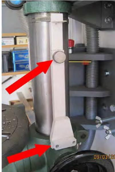
Cette protection est très facilement déplaçable (car elle ne couvre pas la totalité de la course) et même amovible, puisqu'elle n'est fixée que par deux aimants (un en bas, et celui du haut, circulaire, qui permet de maintenir l'emboîtement des deux gouttières lors des mouvements de la table).
