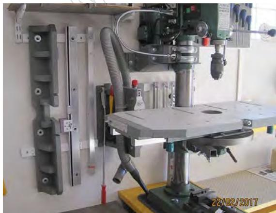
Sur le mur, derrière la perceuse, on distingue deux supports. Sur celui de gauche, on suspend le guide vertical, le guide horizontal ainsi que les deux cornières de la rallonge droite.
