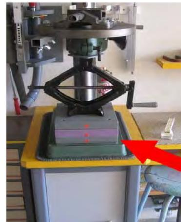
Pour le cas des pièces présentant un porte-à-faux, il est nécessaire de les soutenir avec une servante latérale. Pour obtenir un perçage bien vertical, l'utilisation du niveau est indispensable dès que la pièce est épaisse ou lorsque le trou est traversant.
