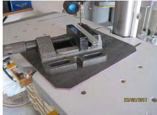
Mentionnons également que la butée micrométrique de l'étau peut aussi s'utiliser sur la table métallique d'origine. Il suffit de la boulonner directement sur l'étau ou dans une des fentes de cette dernière.
