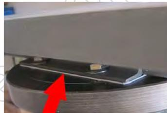
En ce qui concerne le réglage avant/arrière, il faut corriger le défaut de la table métallique d'origine puisque la nouvelle table pour le bois s'utilise sans le cric. Pour cela, une cale en PVC a été glissée sous le tube avant.
