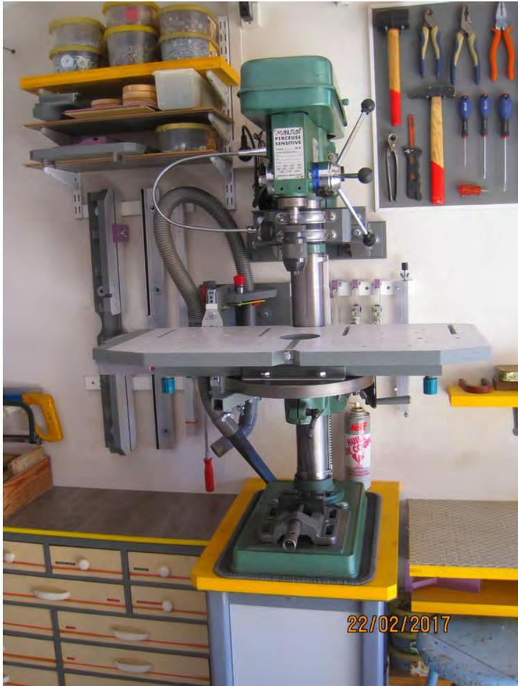
Comme je trouvais la table métallique d'origine de ma perceuse trop petite pour le confort du perçage du bois, j'en ai fabriqué une de plus grandes dimensions. Néanmoins, elle est facilement amovible pour le perçage de l'acier...
