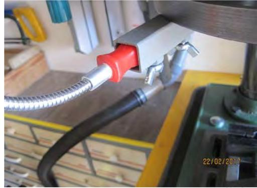
L'extrémité du doigt magnétique a été modifiée pour recevoir un support de tuyau. C'est là que vient s'emboîter l'extrémité du flexible muni d'un petit embout d'aspirateur. Grâce à la souplesse du doigt magnétique, on peut aisément positionner l'embout où l'on veut, au plus près du trou, pour aspirer le maximum de débris.
