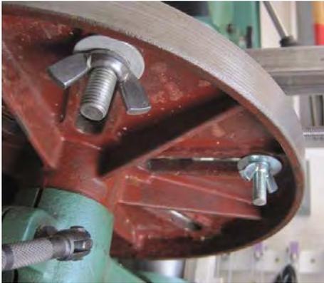
Elle est assurée par quatre boulons Ø10 qui sont positionnés dans les lumières oblongues de la table d'origine. Pour un démontage plus aisé, ils sont équipés d'écrous papillon.
