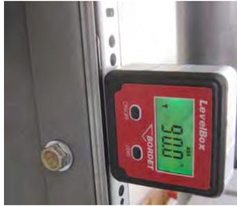
La glissière doit être verticale. Le réglage gauche/droite s'effectue avec les fixations murales du support. Le réglage avant/arrière se réalise avec les trois boulons qui maintiennent la cornière frontale.
