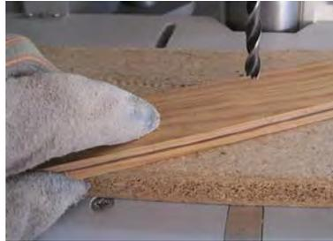
Enfin, et le plus souvent, on peut aussi utiliser un martyr quelconque simplement posé sur la table pour un perçage "à la volée", pièce tenue à la main, gantée, par sécurité.
