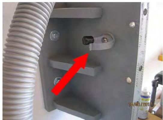
Sous la table métallique d'origine, un tube carré est boulonné dans une de ses fentes. On vient y emboîter le manche d'un doigt magnétique qui sera bloqué par une vis munie d'un écrou papillon.
