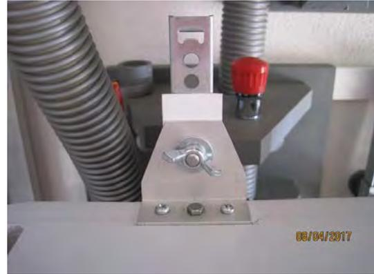
Elle permet la montée et la descente de la table sans jeu dans l'axe du foret. Ainsi, avec une pièce bridée sur la table ou dans l'étau, le changement de foret est possible sans modification du réglage (réalisation d'un avant-trou par exemple).
