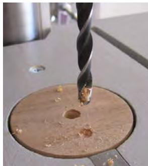
Mais cette cale a tendance à bouger lors de l'opération de perçage. Il faut donc la bloquer. Ainsi, à l'intérieur de la barre d'aluminium centrale, une tige filetée terminée en pointe pousse la cale au fond de son logement et vient se piquer dans son épaisseur.
