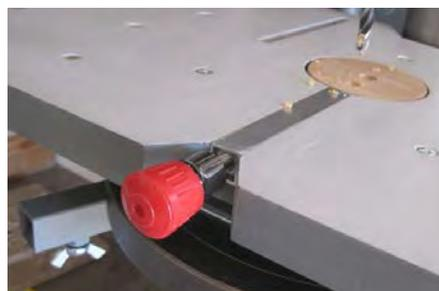
Prendre une douille de clé à pipe de 13. Rechercher un bouchon en plastique quelconque qui vienne s'y emboîter en force. A défaut, se munir d'un exemplaire plus grand et le coller.
