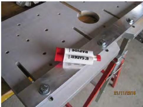
Positionner le guide sur la table et marquer l'emplacement des quatre trous de fixation à 20 du bord arrière ; percer au Ø 10. Coller (époxy) sur le dessus des grosses rondelles Ø 27.
