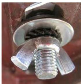
La fixation de cette nouvelle table sur la table métallique d'origine s'effectue par 4 boulons Ø 10 munis de rondelles à ailettes et d'écrous papillon. Ils utilisent ses fentes oblongues.
