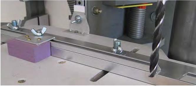
Le curseur est maintenu en position par un écrou papillon sur une rondelle.
