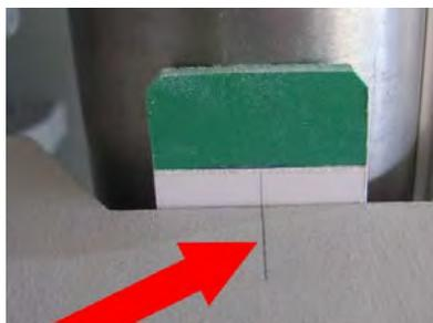
Coller (colle PVC) le petit morceau sur le grand, à 15mm du bord supérieur. Tracer au porte-mine la ligne verticale médiane. Casser les deux angles supérieurs à la lime.
