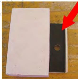
Façonner un boulon poêlier de 6x15 : meuler le dessus et limer les côtés pour qu'il puisse coulisser dans le rail. Débiter une bande de plastique (couverture classeur) de 50 x 115 et la coller au double face au fond de la cornière, percer  $\varnothing 6$ .
