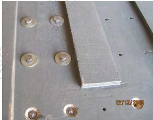
Au recto, coller les fers au double face en ayant la tête d'un boulon en situation et percer au Ø 3. Pour les quatre trous des extrémités, il faut noyer les écrous dans l'épaisseur du bois. Pour les autres, les boulons seront coupés et limés au ras de leur écrou.
