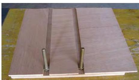
Tracer les axes selon le schéma et coller les trois petits morceaux sur le grand séparés de 12,5 mm. Au moment du collage placer des boulons M8 dans les rainures pour vérifier leur bon coulisement.
