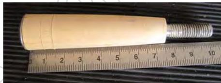
Pour le façonnage de la poignée de 75 de longueur, c'est la même procédure que pour celle du cric. On fera un trou de part en part au  $\varnothing 8$  et on utilisera un boulon à tête bombée dont on aura limé les carrés situés en-dessous de sa tête.
