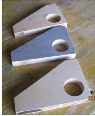
Pour les renforts, débiter 3 morceaux de CP épaisseur 20 de 150 x 100 et façonner les grands renforts selon le schéma. Réaliser un trou  $\text{Ø} 40$  à la scie cloche (ou avec une mèche type Forstner).
