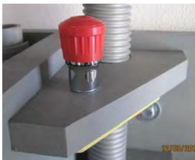
Pour ranger la douille avec son bouchon, il suffira de visser sur le dessus du renfort du haut du support mural un écrou de M8. La douille viendra simplement s'y emboîter.
