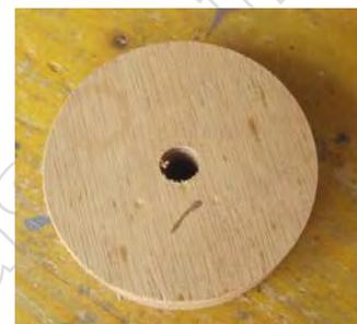
CP ou latté de 25 d'épaisseur (coller des morceaux pour obtenir cette épaisseur) : pratiquer un trou à la scie cloche  $\varnothing 75$ . On obtient un anneau de 70 de diamètre extérieur et de 10 de diamètre intérieur (trou du foret de la scie cloche).
