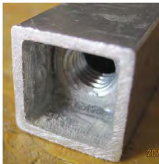
Limer légèrement deux écrous M8 de manière à ce qu'ils puissent rentrer à l'intérieur du tube carré. Sur une extrémité coller un écrou à la colle époxy à 8 mm en retrait.
