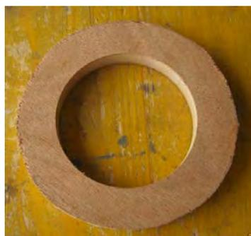
CP ou latté de 16 : tracer un cercle de 125 de diamètre. Au centre pratiquer un trou  $\varnothing 80$  à la scie cloche. Découper le cercle extérieur à la scie sauteuse. On obtient ainsi le premier anneau
