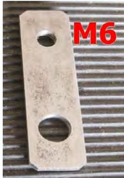
Débiter dans un fer plat de 15 une longueur de 50. A 10 de chaque extrémité, percer un trou  $\varnothing 8$  d'un côté et un trou  $\varnothing 5$  de l'autre. Tarauder le trou  $\varnothing 5$  en M6.
