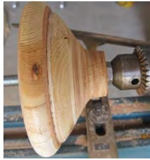
Enlever l'écrou et monter l'assemblage sur le tour (j'ai placé une butée cylindrique en bois sur la poupée fixe car je n'avais pas encore eu l'idée d'utiliser une deuxième perceuse). Façonner le volant en adoucissant les angles des différents anneaux pour donner la forme du volant.
