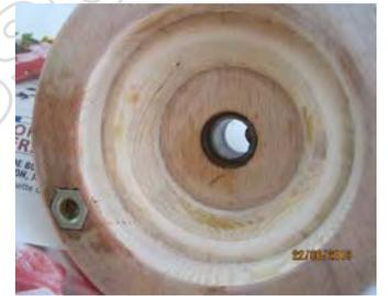
Réduire l'épaisseur de l'écrou à la lime. Coller avec de la colle époxy le tube cannelé central et l'écrou (afin d'éviter d'avoir de la colle sur les taraudages, mettre un peu de graisse dans l'écrou et le trou perpendiculaire du tube cannelé).
