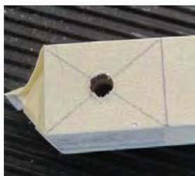
Pour effectuer le montage, ajuster les dimensions des CP d'épaisseur 12 à la lime et les peindre.
