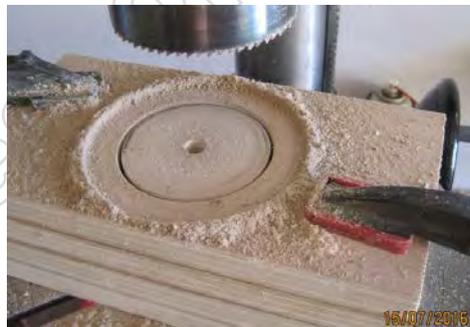
Après séchage, poncer l'arrière puis marquer le milieu de la longueur et tracer l'axe de symétrie. A 63 du bord arrière, faire un avant-trou  $\text{Ø}10$  traversant qui va servir de guide, puis percer à la scie cloche au diamètre 74 en retournant la pièce (2 fois 36).
