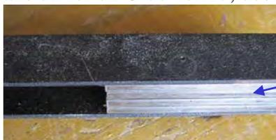
Débiter 3 morceaux de CP de 50 x 15 de 4 d'épaisseur. Les coller entre eux et les rentrer en force à une extrémité.
