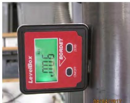
Serrer fortement. La colonne de la perceuse ne doit pas bouger : vérifier qu'elle est toujours bien verticale. Si ce n'est plus le cas, on peut glisser derrière la colonne une ou deux feuilles de papier, un carton fin ou un morceau de couverture de classeur en PVC jusqu'à obtenir un résultat optimal.
