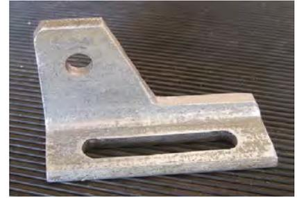
Percer 5 trous  $\varnothing 8$  et les rejoindre à la lime pour former une lumière de 45 de longueur.
