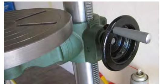
Le volant à manivelle en place sur la machine.
