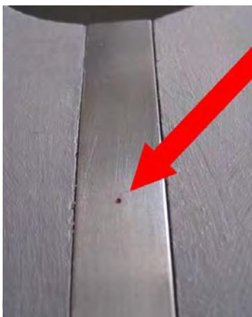
Dans une cornière en aluminium de 23 x 23 avec le milieu marqué à l'intérieur par une rainure, débiter un morceau de 225 de longueur. Couper ses deux angles supérieurs à 45°. Sur le devant, (voir photo ci-dessous) marquer la rainure d'un trait de scie à métaux.
