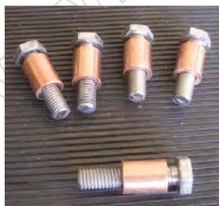
Préparer 4 boulons M8 à 35 de longueur (limer légèrement le dessus de la tête et émousser le pas de vis en bas sur 5 de haut pour un meilleur coulisement).
