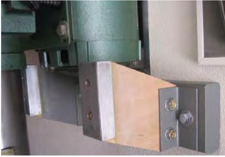
Amincir légèrement l'épaisseur à la lime et rentrer le fer en U en force. Effectuer un pré-vissage sur l'étau avec des tirefonds de 8x50. Fixer au mur le support principal avec des tirefonds de 8x80 qui maintiennent également les équerres. Les boulons horizontaux de 8 sont munis d'écrous frein pour pallier aux éventuelles vibrations.
