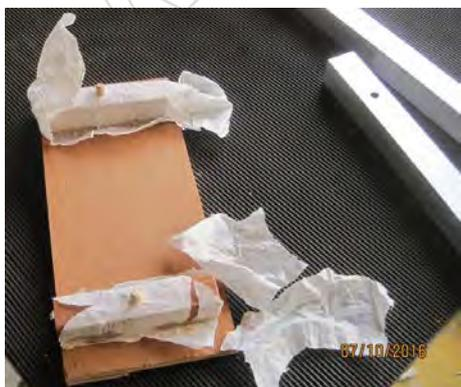
Utiliser maintenant du papier très fin (utilisé pour bourrer et protéger les chaussures dans les boîtes). Mettre en situation les tasseaux dans les U en emboîtant le tourillon dans le trou au travers du papier et coller dessus les morceaux de CP, affleurant le bord extérieur. Maintenir fermement avec des pinces.
