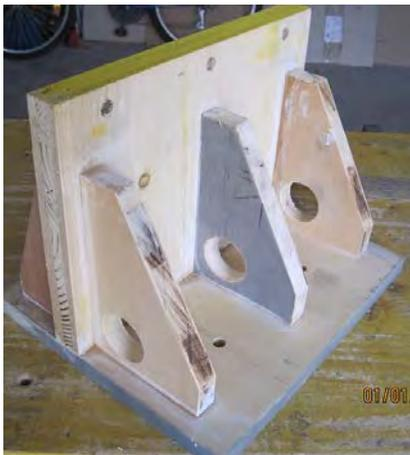
Coller et visser le montant vertical sur le socle. Coller en même temps les renforts latéraux à 15 des bords en haut et en bas et le central au milieu.
