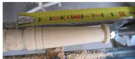
Réalisation de la poignée avec un morceau de bois cylindrique de récupération : perçage à la perceuse à colonne, façonnage sur le tour à bois, montage sur la pièce en U avec un contre-écrou pour permettre sa rotation. Longueur de la poignée : 80 mm
