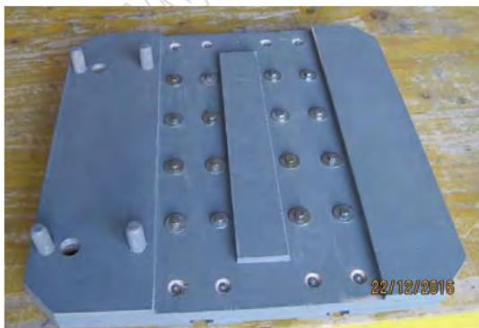
Dans les trous Ø 10, coller des tourillons de 10 qui dépassent de 20. Mettre en peinture. Au recto, coller des rondelles Ø 27 sur les deux trous.
