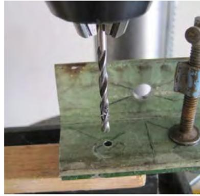
Coller des morceaux de contre-plaqué de 250 x 150 environ jusqu'à obtenir une épaisseur de 38. Après séchage, débiter deux carrés de 120 x 120. Sur chacun, percer 2 trous  $\text{\O} 8,5$  selon le schéma :
