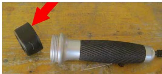
Pour le filtre bleu, j'ai utilisé un intercalaire transparent bleu pour classeur. J'y ai découpé un cercle. Le hublot provient d'une lampe torche. Il vient simplement s'emboîter, son diamètre correspondant à celui de la lampe.
