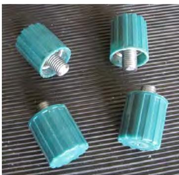
Enfin, pour les boutons de serrage, on peut utiliser des bouchons en matière plastique (Pétrole Hahn, en l'occurrence). Utiliser des boulons Ø 10 en plaçant un écrou au ras de la tête. Débiter un manchon de 20 de longueur dans un tube PVC Ø 22 (raccord de tube électrique IRO). Placer de la colle néoprène au fond du bouchon.
