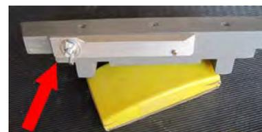
Positionner la pièce sur le taquet à hauteur du CP de dessous. Percer le taquet de part en part et fraiser le verso. Utiliser un boulon de 8x50 tête fraisée et un écrou papillon. A l'autre extrémité, placer une petite vis au niveau de l'encoche inférieure pour supporter la cornière en position horizontale.
