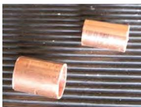
Pour réaliser les entretoises, débiter 5 morceaux de 17 dans du tuyau de cuivre  $\text{\O} 8.10$  et 5 autres dans du tuyau de  $\text{\O} 10.12$ . Emboîter le cuivre l'un dans l'autre en force de façon à avoir  $\text{\O} 8$  intérieur et  $\text{\O} 12$  extérieur. A la lime, ramener la longueur à 16.
