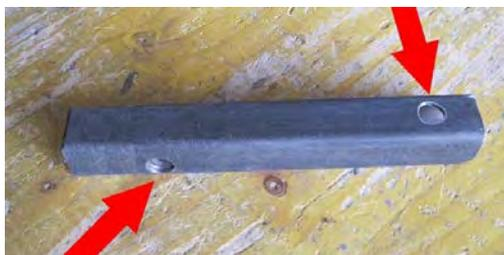
Percer transversalement à 30 de l'extrémité et sur le dessus à 15 de l'autre extrémité, les deux trous au Ø 8.
