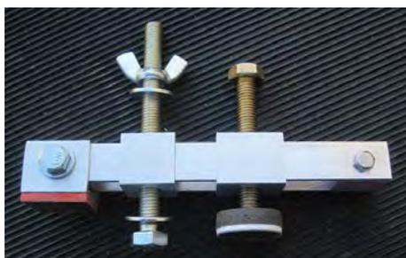
Mettre en place le boulon de 4 avec un écrou imperdable. Utiliser un écrou imperdable pour le boulon de 6 en laissant le basculement de la pièce en U souple. Contrôler le bon fonctionnement de l'ensemble. Coller avec du double face un morceau de papier de verre grain 240 sur la pièce en PVC de 25 x 20 et la coller sous la pièce en U, également au double face.
