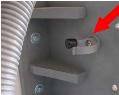
Pour bien le maintenir en place, visser sur le côté une fixation pour tuyau en PVC. Couper un côté sur la moitié de sa longueur environ et placer un embout qui formera une excroissance qui maintiendra le tuyau en place.
