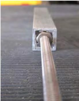
De l'autre côté, coller toujours à l'époxy les deux petites cornières à l'intérieur du carré. Mettre en place la tige filetée intérieure et coller un écrou à l'intérieur des cornières affleurant l'extrémité (placer le tube verticalement dans un étau).
