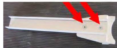
Au verso, positionner et coller, avec un petit morceau de double face, un aimant de fermeture magnétique. Visser ensuite avec deux vis de 2,5x20.
