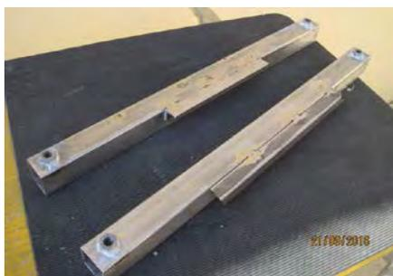
Débiter un tube carré en fer de 20 x 20 de 240 de longueur et une cornière en fer de 15 x 15 de 190 de longueur. Souder sur le milieu des tubes de 35, affleurant le dessous. Réaliser trois points de soudure pour ne pas déformer, meuler soigneusement les bavures.
