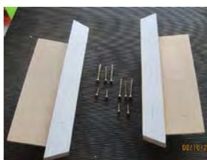
Après séchage, ajouter 3 vis dans le taquet et une vis dans chaque liteau. Mettre en peinture
