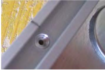
Sur chaque partie, percer 3 trous au  $\varnothing 3$  et fraiser avec un foret  $\varnothing 5,5$  (placer de l'adhésif sur le foret pour ne pas abîmer les bords du rail). Utiliser des vis 2,5x10 à tête fraisée.
