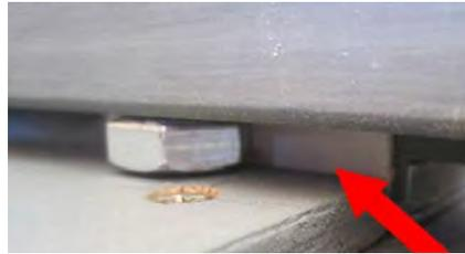
Sur le tube arrière, ils traversent le petit tube carré soudé. Pour les bloquer en rotation, il est nécessaire d'ajouter une fine bande de PVC de 15 de hauteur (collée au double face) contre le haut du tube principal
