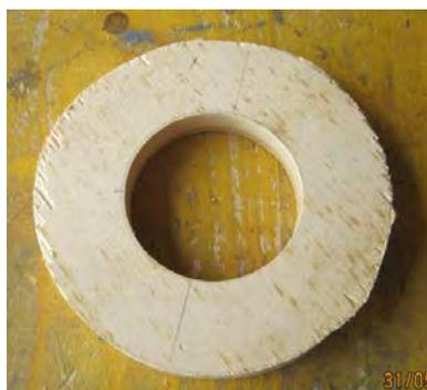
Réaliser de même le deuxième anneau de 100 de diamètre extérieur et 50 de diamètre intérieur
