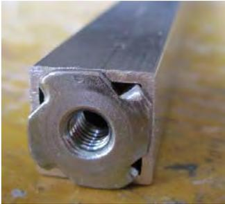
Sur le morceau qui est coupé à angles droits, sur une extrémité coller un écrou à frapper M6 à la colle époxy, laisser sécher.
