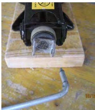
Se procurer un cric losange de voiture dans une casse automobile. On va enlever la "poignée" d'origine et la remplacer par une manivelle.
