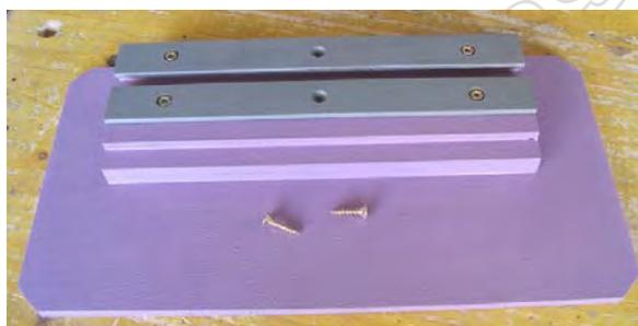
Débiter deux morceaux de 190 dans du fer plat de 20. Sur chacun, percer trois trous  $\text{\O} 3$  sur l'axe médian, 1 au milieu et 2 à 30 des extrémités.
