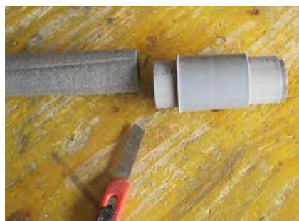
Il est adapté pour une loupe muni d'un manche cylindrique. Utiliser un manchon PVC Ø 32 et découper deux morceaux de tuyau PVC Ø 32, l'un de 35 et l'autre de 40. Emboîter les deux morceaux de tuyau dans le manchon.
