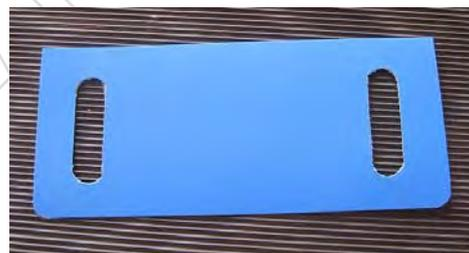
Percer deux trous Ø 12 aux extrémités, puis les rejoindre en utilisant une règle et un cutter.
