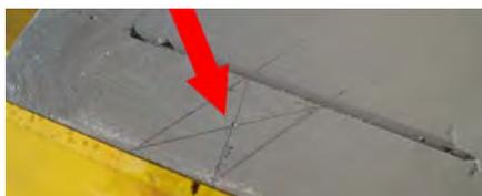
Marquer l'emplacement des trous de fixation par le dessous de la table métallique dans les fentes oblongues. On obtient des parallélogrammes ; percer au centre selon les diagonales au Ø 10.
