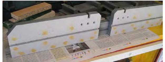
Pour confectionner le curseur, il convient de débiter un morceau de CP de 70 x 45 de 15 mm d'épaisseur et un morceau de PVC de 1,5 d'épaisseur de 45 x 15. Coller le PVC avec du double face. Percer au Ø 6.
