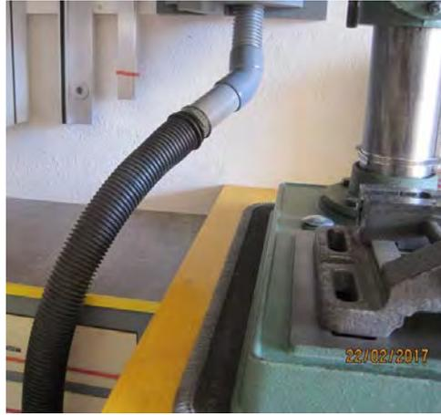
Récupérer un tuyau flexible d'aspirateur d'une longueur d'un mètre environ. Le faire passer dans les trois trous superposés du support mural.
