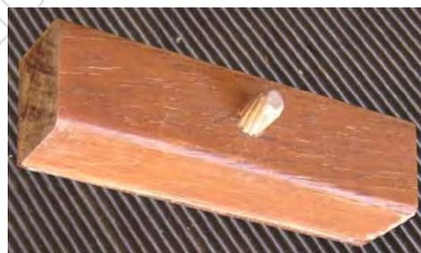
Débiter deux morceaux de CP de 220 x 90 et deux autres de 220 x 35 épaisseur 6 (à défaut on peut utiliser des morceaux de MDF de 3 collés). Coller le petit morceau sur le grand, affleurant à un bord.
