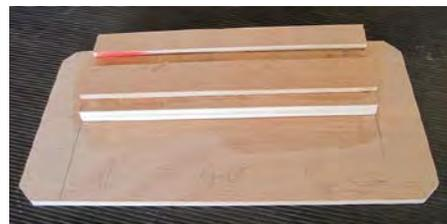
Coller le morceau épais sur le plus grand, affleurant en haut à 30 de chaque côté. Sur le dessus, coller le morceau de 20 affleurant en haut, puis celui de 25, séparé de 12,5 mm en dessous. Pendant le collage, placer un boulon M8 dans la rainure pour vérifier qu'il puisse y coulisser correctement.
