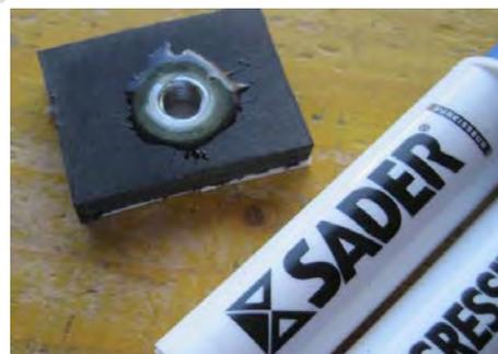
Sur le PVC, coller un morceau de papier de verre de grain 240. Casser grossièrement les angles du PVC et poncer l'excès de colle au niveau de l'écrou. Rendre la pièce circulaire au tour.
