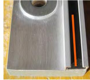
Débiter deux bandes de plastique dans une couverture de classeur de 330 x 12. Aux deux extrémités, coller avec du double face un petit morceau de plastique (12 x 10) de 1 d'épaisseur. Présenter la bande dans le rail et ajuster sa longueur avec une petite lime. Ajouter un petit morceau de double face aux extrémités, mettre en place en retournant le guide, puis presser aux extrémités pour coller la bande cache vis (repérée par un trait rouge).
