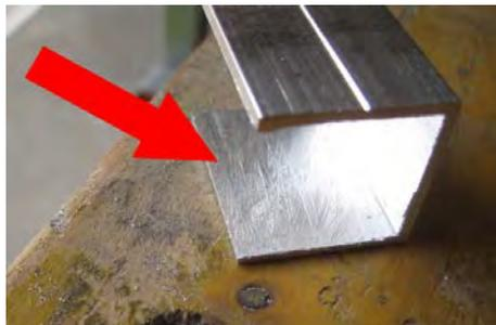
Transformer le deuxième carré de 25 en U. Limer soigneusement l'intérieur de la découpe.
