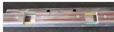
Boulonner le plateau sur les tubes pour s'en servir de guide de perçage.
