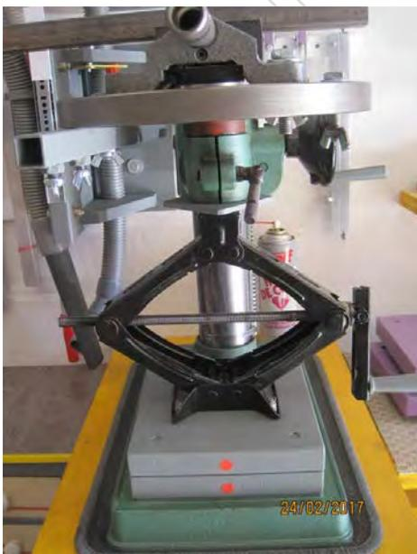
Boulonner la plaque de fer et la rondelle conique en PVC sur le dessus du cric. Du fait de la conicité de la partie supérieure, le cric effectuera en remontant un auto-centrage.
