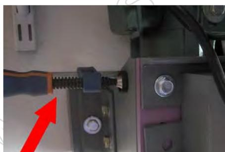
Au montage, placer un serre-joint sur la pièce verticale pour éviter tout risque de fendre.
