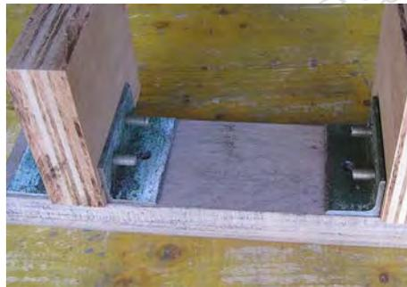
Découper deux angles et sur l'épaisseur correspondante, percer 2 trous  $\text{\O} 5$  de 15 de profondeur :
