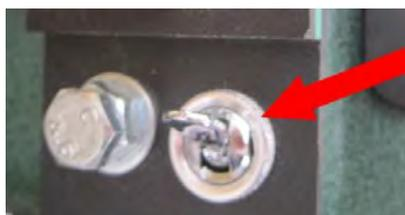
Pour fixer la lampe sur la perceuse, je me suis servi d'un trou taraudé au  $\text{Ø} 8$  déjà présent sur le côté de la machine et j'ai percé le capot des courroies par en-dessous de deux trous  $\text{Ø} 5$ . Je n'ai pas utilisé l'interrupteur d'origine mais un modèle encastré qui est vissé en bas à droite de la plaque de PVC.
