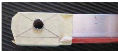
Enfiler sur les montants la pièce coulissante rectangulaire avec l'écrou situé en haut, puis la pièce coulissante carrée. Mettre en place le morceau de 25 x 15 entre les deux barres avec du double face. Positionner la pièce en U, placer une cale de 3 d'épaisseur dessous pour le jeu et entourer d'adhésif papier. Tracer le centre par rapport aux barres métalliques et percer au  $\varnothing 6$  les 4 pièces ensemble.
