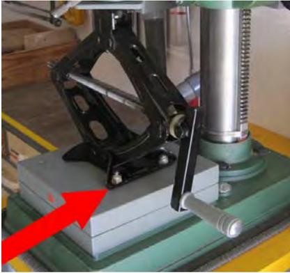
Le cric sera boulonné sur le dessus de la pièce C, dans l'aplomb de la table métallique de la machine. Quatre trous  $\varnothing 8$  ont été percés dans sa base. Les quatre boulons à tête fraisée sont munis d'écrous à frein.
