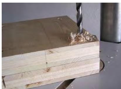
Réunir les trois morceaux avec de l'adhésif double face. Marquer la face avant avec un coup de pointeau. Percer ensemble au Ø 10 à 25 de chaque bord.
