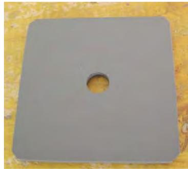
La partie supérieure du cric est percée au  $\varnothing 12$ . Débiter une plaque de fer de  $80 \times 80$  de 6 d'épaisseur. Casser ses angles à la lime et percer en son centre un trou  $\varnothing 12$
