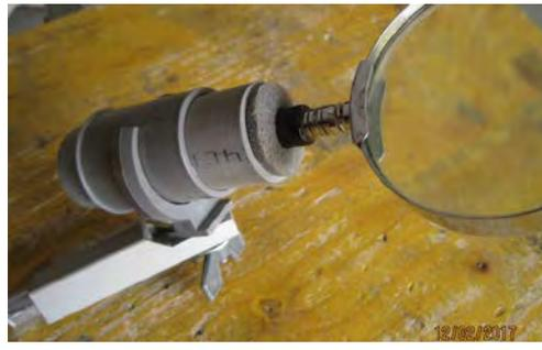
Enfoncer en force un morceau de manchon mousse pour la protection des tuyaux de Ø 30. Couper l'excédent de mousse au cutter. Pour l'utiliser, la loupe remplace le suceur d'aspiration sur son support. Il suffit de la glisser dans le support ouvert Ø 40 situé au bout du doigt magnétique
