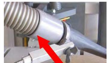
Pour l'autre extrémité, récupérer un suceur d'aspirateur. Débiter un morceau de tuyau PVC Ø 32 (fin) de 90 de longueur et un morceau de Ø 40 de 45 de longueur. Coller les deux pièces sur le suceur (colle PVC). Après séchage, coller un manchon Ø 40 au ras du suceur (enfoncement de 27).
