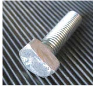
Sur le tube avant, les boulons sont situés sur la cornière frontale. Il faut leur couper 2 pans au ras de la vis. En effet, la largeur de la cornière ne permet pas de conserver l'intégrité de leur tête et ils sont ainsi bloqués en rotation, ce qui facilite leur serrage.
