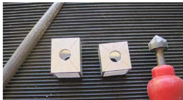
Percer au Ø 8 de part en part en leur centre une pièce de 25 et celle de 20 (coller du papier adhésif pour faciliter le traçage). Coller (époxy) à l'intérieur de la pièce de 25 un écrou M8 :
