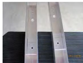
Coller le PVC sur le plat d'aluminium au double face à une extrémité. Marquer le centre et placer un petit morceau de double face au verso. Mettre en place le taquet dans la cornière en U, en enclenchant le tourillon dans son trou. Coller l'attache au fond du rail en U en appuyant à 2 mm en retrait par rapport à la cornière. Percer au Ø 3 l'attache et le U. Fraiser en dessous. Boulonner avec des boulons de 3x10. Vérifier le bon fonctionnement.
