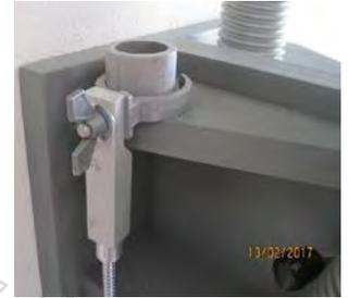
Pour le rangement, débiter un morceau de tuyau PVC Ø 32 de 25 de longueur. Avec la scie cloche, découper un cylindre Ø 23 de 10 d'épaisseur dans un chute. Coller les deux pièces. Après séchage, visser sur le dessus du premier renfort du support mural à gauche.
