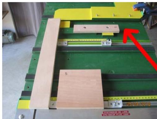
On peut aussi relier les curseurs par une barrette d'aluminium, et ajouter la cale à aiguille avec des équerres de maintien sur la longueur.
