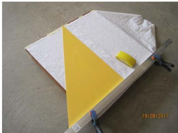
Après découpe, les deux traits de crayon obtenus par retournement sur le côté 700 sont strictement parallèles à l'œil et à une mesure minutieuse au réglet. C'est la méthode employée pour vérifier une équerre et l'on sait que l'erreur trouvée est doublée par rapport à la coupe. Donc, si l'on ne peut affirmer que l'angle est exactement de 90°, on est certain d'en être très proche...
