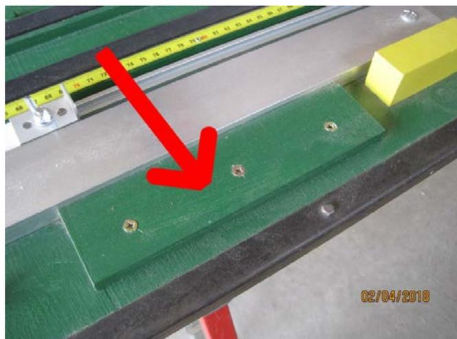
La règle est boulonnée sur la table et bloquée en position perpendiculaire par une cale après son réglage.
