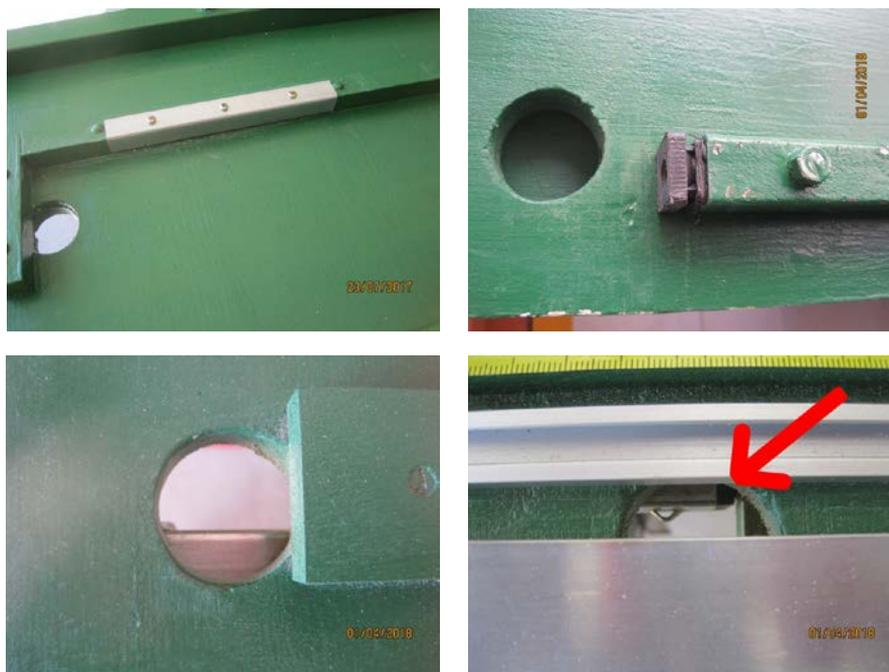
Les quatre grands trous permettent de vérifier, visuellement, par le dessus, que les tréteaux sont bien en place sous la table
