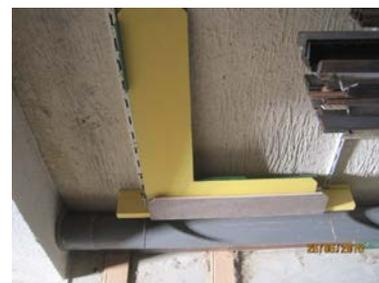
La petite boîte métallique contient les vis et la cale perforée. Derrière la table, sur ses supports muraux, se trouve une petite étagère avec les bandes pour la servante et la grande cale en équerre. Enfin, la barrette est maintenue sur la table, avec ajout d'un arrêt pour éviter son glissement.
