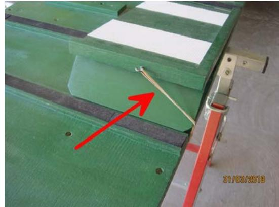
Pour découper des pièces de grandes dimensions, la table sera en position horizontale : le réglage des deux tréteaux au niveau 2 s'en charge. En effet, dans ce cas, l'inclinaison serait une gêne.
