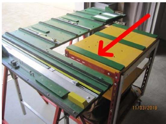
Une servante sur roulettes peut être ajoutée. On ajoute 3 bandes de bois pour être au niveau exact des bandes de caoutchouc. La forme en L est ainsi comblée et me maintient du panneau assuré...
