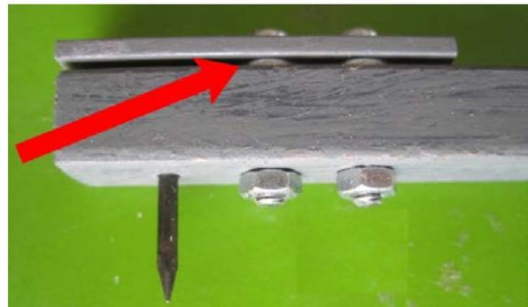
Couper les boulons presque au ras des écrous et les limer pour éviter de se blesser. L'ensemble démontable permet de remplacer facilement la pointe lorsqu'elle sera émoussée.
