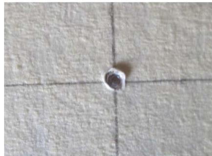
Le problème, lorsque l'on utilise un pointeau, c'est que son cône masque en partie le tracé. On risque d'obtenir alors un pointage légèrement décalé.
